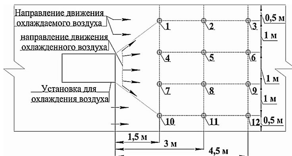
Рисунок 3.9 – Схема проведения эксперимента в наклонном стволе учебной шахты (вид сверху):
