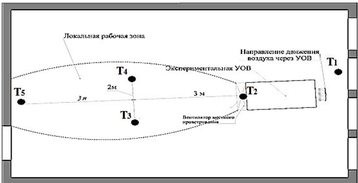
Рисунок 3.6 – Схема проведения экспериментальных исследований по охлаждению модели локальной рабочей зоны, в которой ослаблена проточная вентиляция
