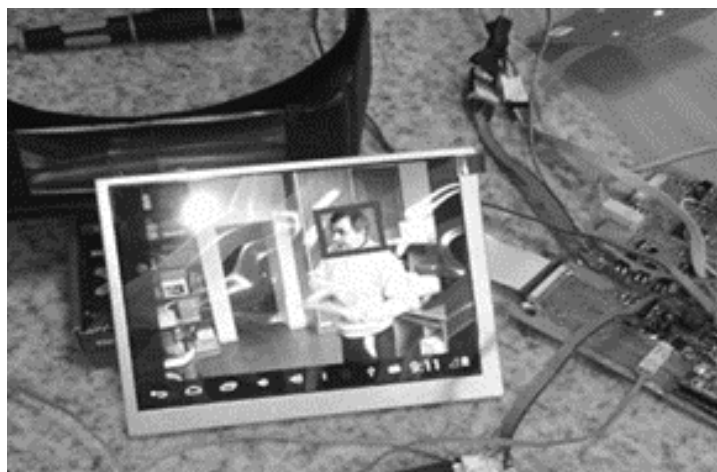
Рисунок 3 – Процесс распознавания лица на мониторе видеодомофона М-480М
