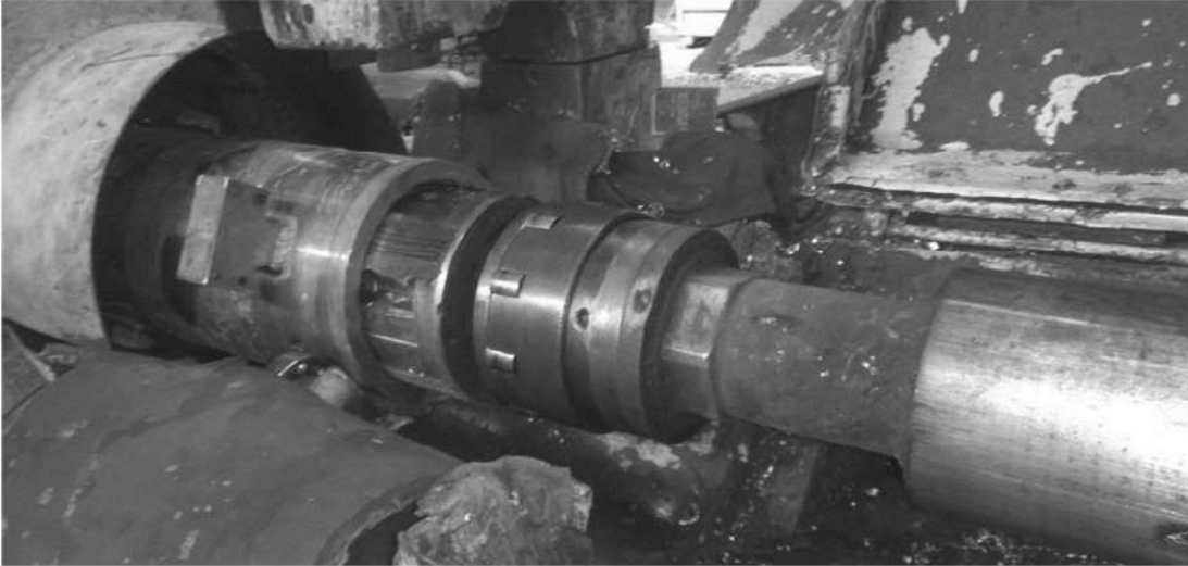
Рисунок 4 - Экспериментальная установка для электромеханической обработки внутренних поверхностей гидроцилиндров.
