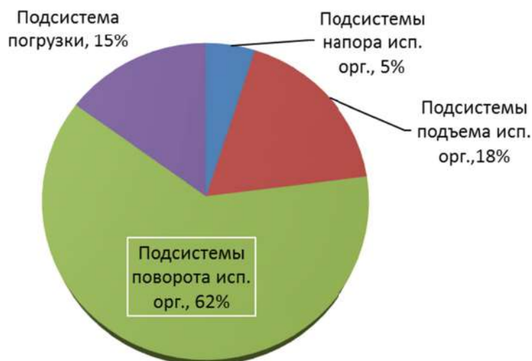
Рисунок 2 - Диаграмма отказов гидравлических подсистем ПК КСП-32
