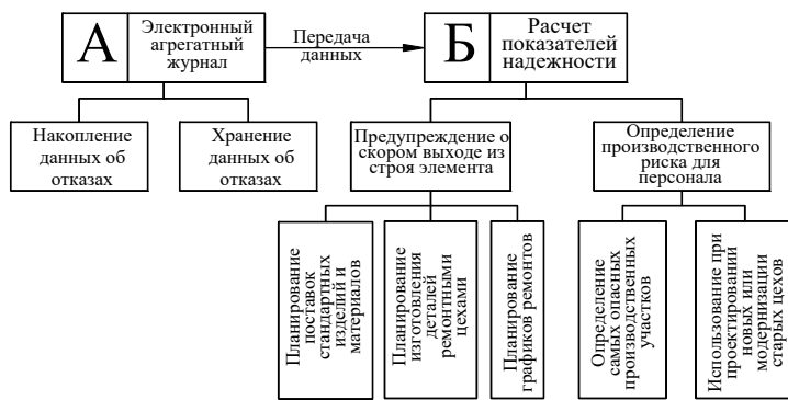
Рисунок 2. Схема описания системы прогнозирования отказа оборудования
