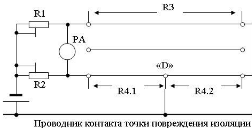
Рисунок 2.14 – Схема, иллюстрирующая концепцию петлевого метода определения места (точка «D») повреждения изоляции фазы кабеля
