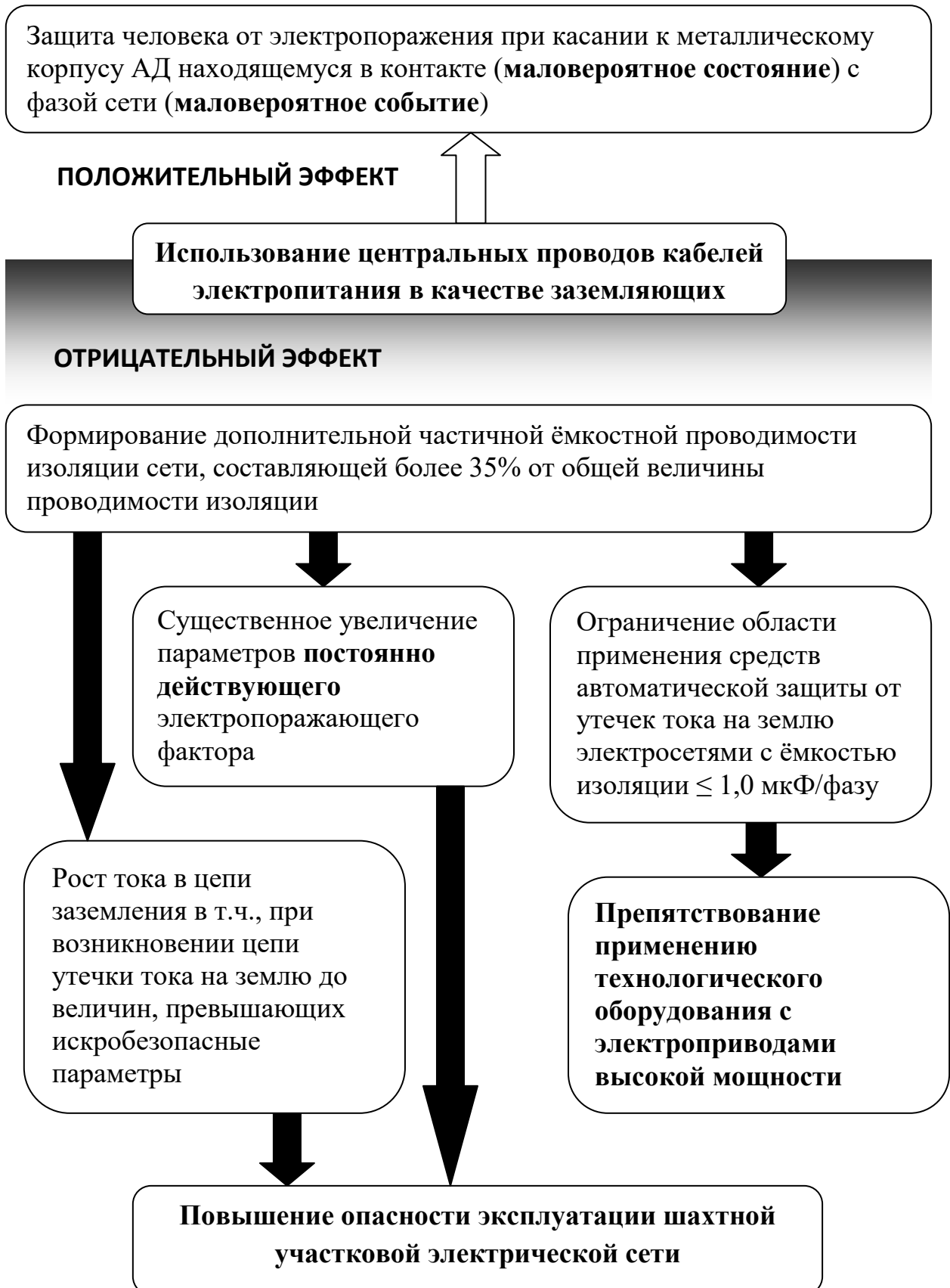
Рисунок 2.7 - Структура значимых факторов, обусловленных использованием центральных проводов кабелей электропитания в качестве заземляющих при эксплуатации электрической сети участка шахты
