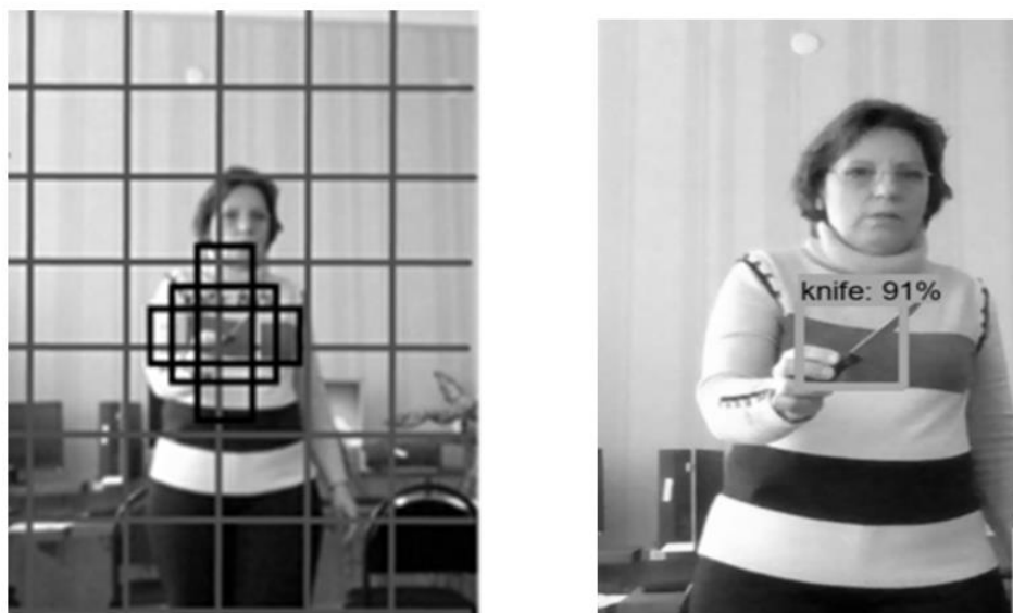
Рисунок 3.49 – Процесс распознавания с разграничивающей сеткой и тремя якорями (слева), результат распознавания ножа, зажатого нехарактерным хватом (справа)
