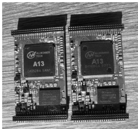
Рисунок 3.50 – модуль с установленной Allwinner A-13 и ПЗУ
