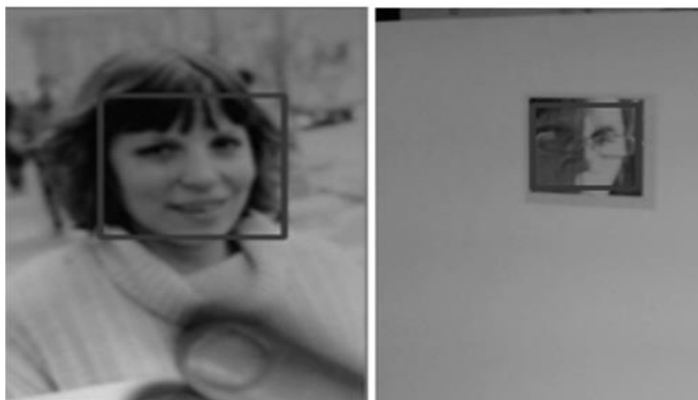
Рисунок 3.45 – Алгоритм выделяет лицо на фотографии, но не распознает его, справа – фотография, сделанная фотоаппаратом, слева – распечатанное изображение из базы данных
