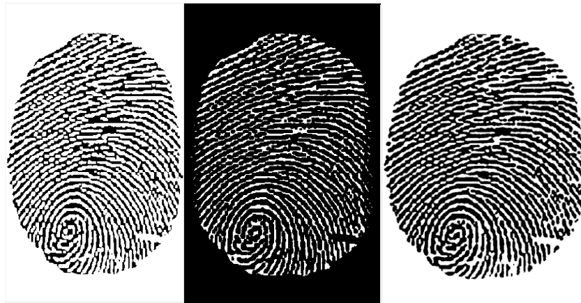
Рисунок 3.26 – Бинаризация отпечатка методами Отцу, Ниблейка и итерационным алгоритмом с обработкой краев изображения
