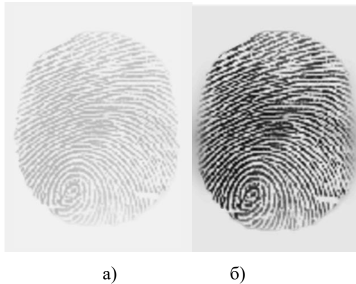
Рисунок 3.23 – Изображение отпечатка, полученное с помощью поиска границ повышения контраста: а) полутоновое изображение, б) улучшенное изображение
