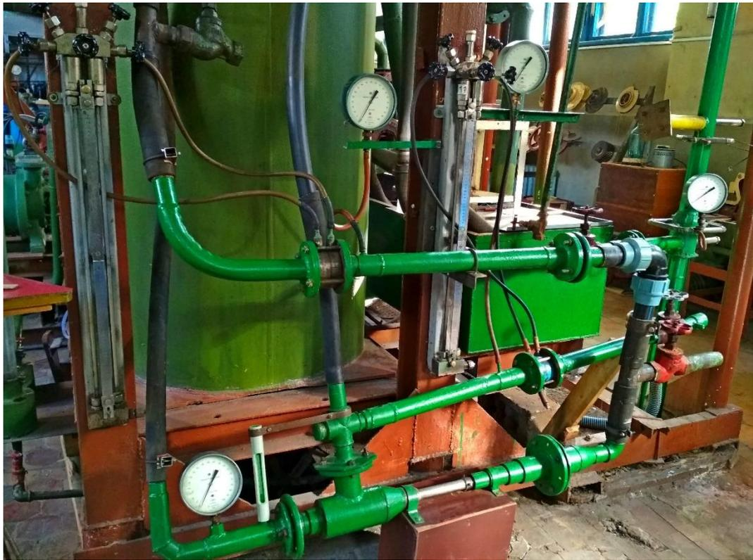
Рисунок 4.2 – Общий вид экспериментальной установки нагнетательного эрлифта с воздухоструйным компрессором
