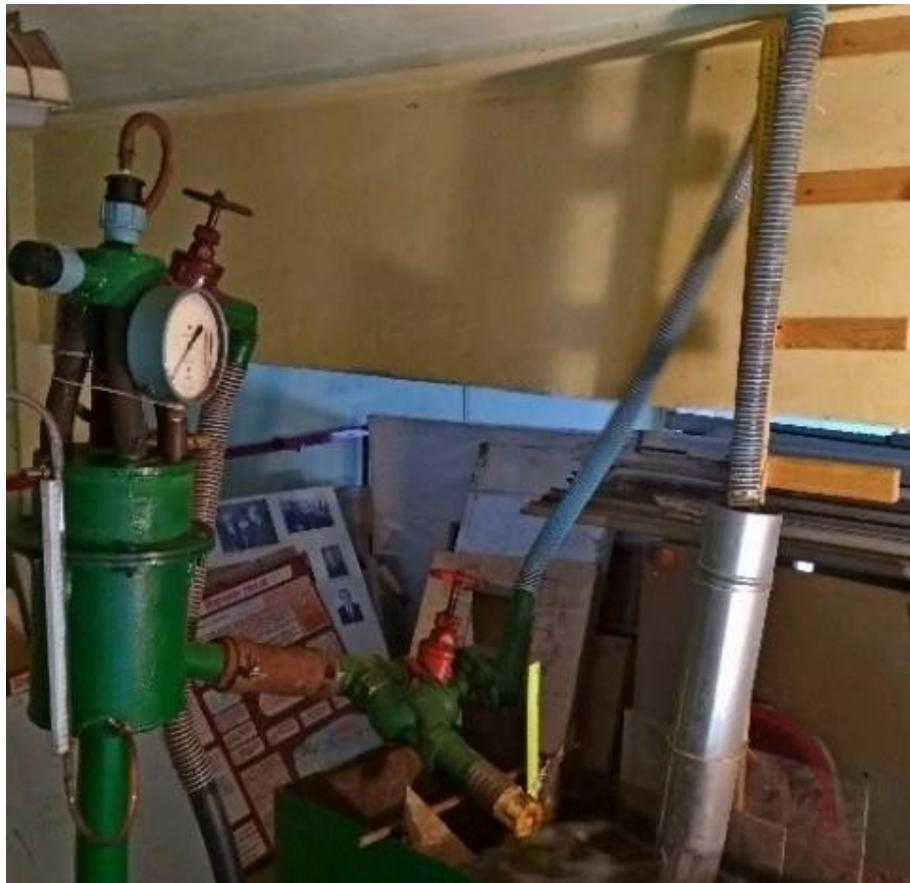
Рисунок 4.3 – Воздухоотделитель и измерительная емкость экспериментальной установки в негнетательном режиме работы
