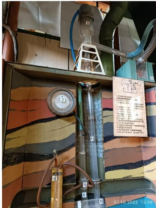
Рисунок 4.20 – Лабораторная установка нагнетательного эрлифта с радиальным нагнетателем
