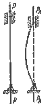
Рисунок 2.2 – Схема анкера под действием нагрузки в начальный момент закрепления породного массива
