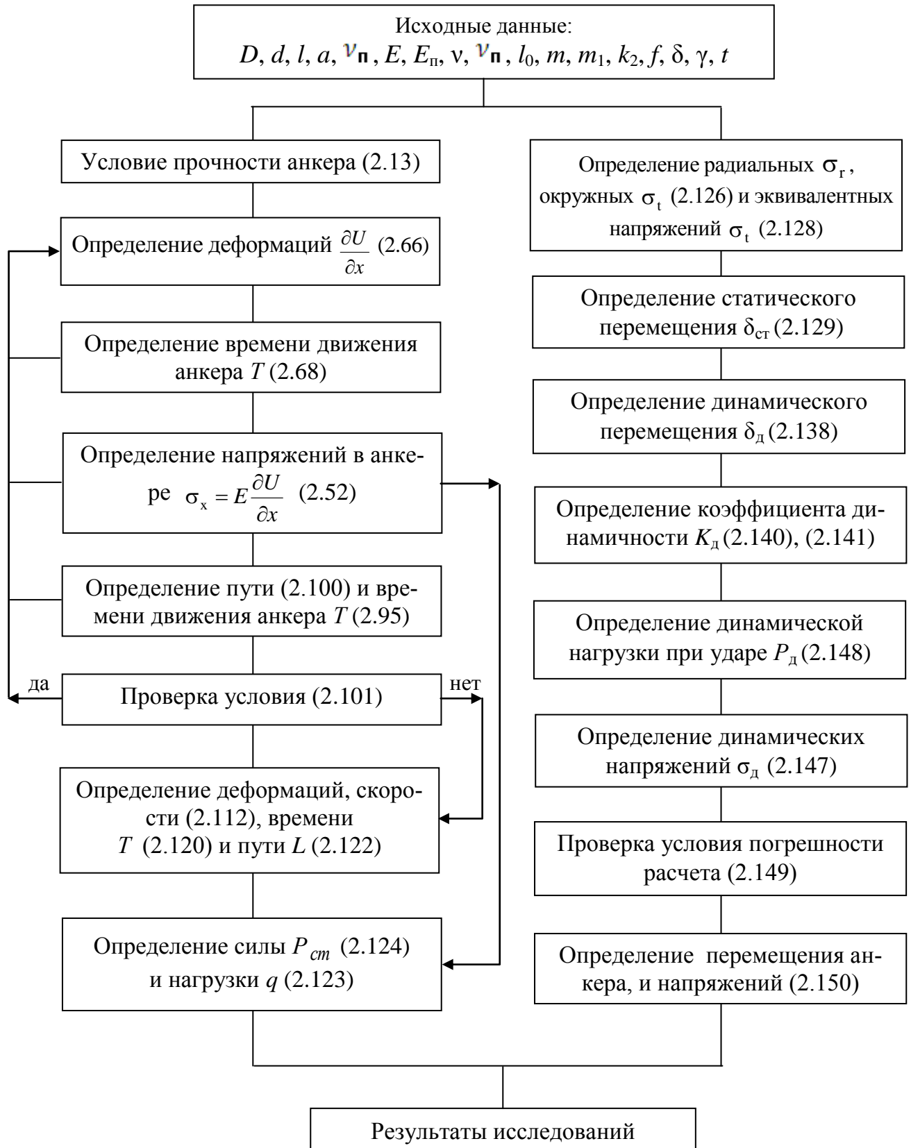
Рисунок 2.6 – Структурная блок-схема алгоритма решения задачи для определения напряжений в анкере и породном массиве под действием ударной нагрузки
