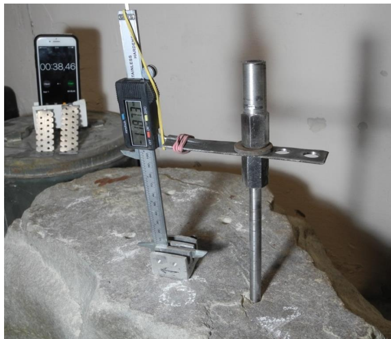
Рисунок 3.4 – Расположение оборудования при закреплении анкера динамической нагрузкой
