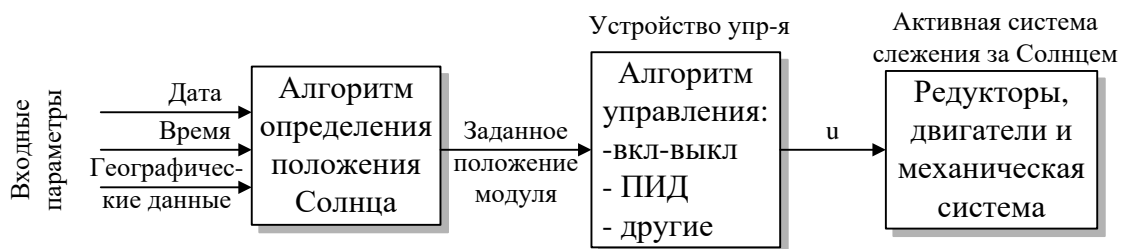
Рисунок 1.18 – Структурная схема активной системы слежения за солнцем без фотодатчика обратной связи на базе алгоритма определения положения Солнца
