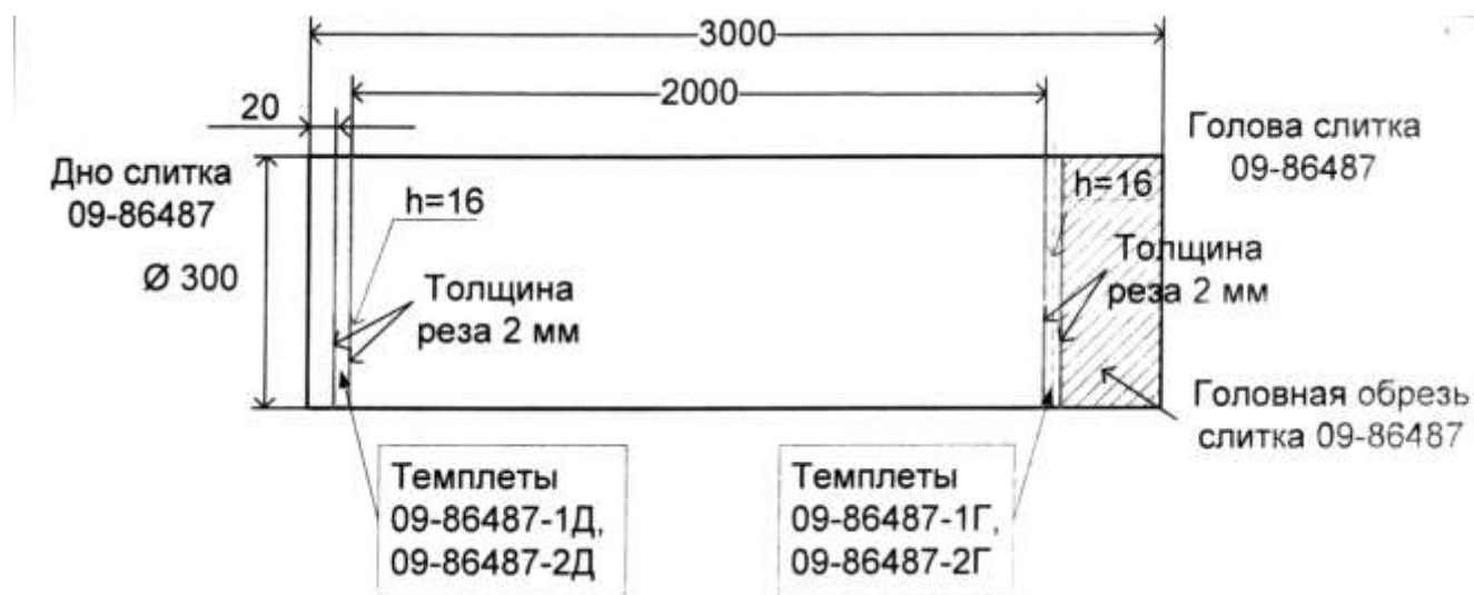
Рисунок 2.2. Схема порезки слитков плавки 09-86487 при подготовке к электрошлаковому переплаву стали 12X18AG18
