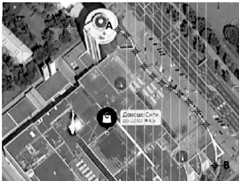
Рисунок 3.10 – Нанесение десяти промежуточных точек
