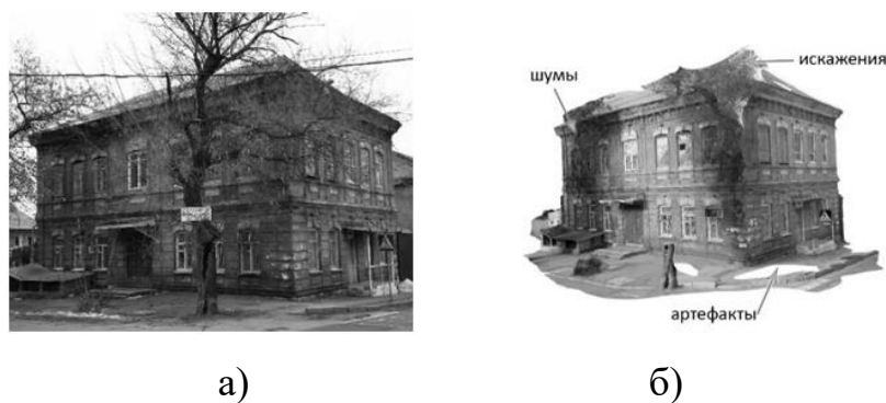
Рисунок 1.6 – Создание трехмерной модели объекта в фотограмметрическом редакторе: а) эталонный объект; б) трехмерная модель объекта.
