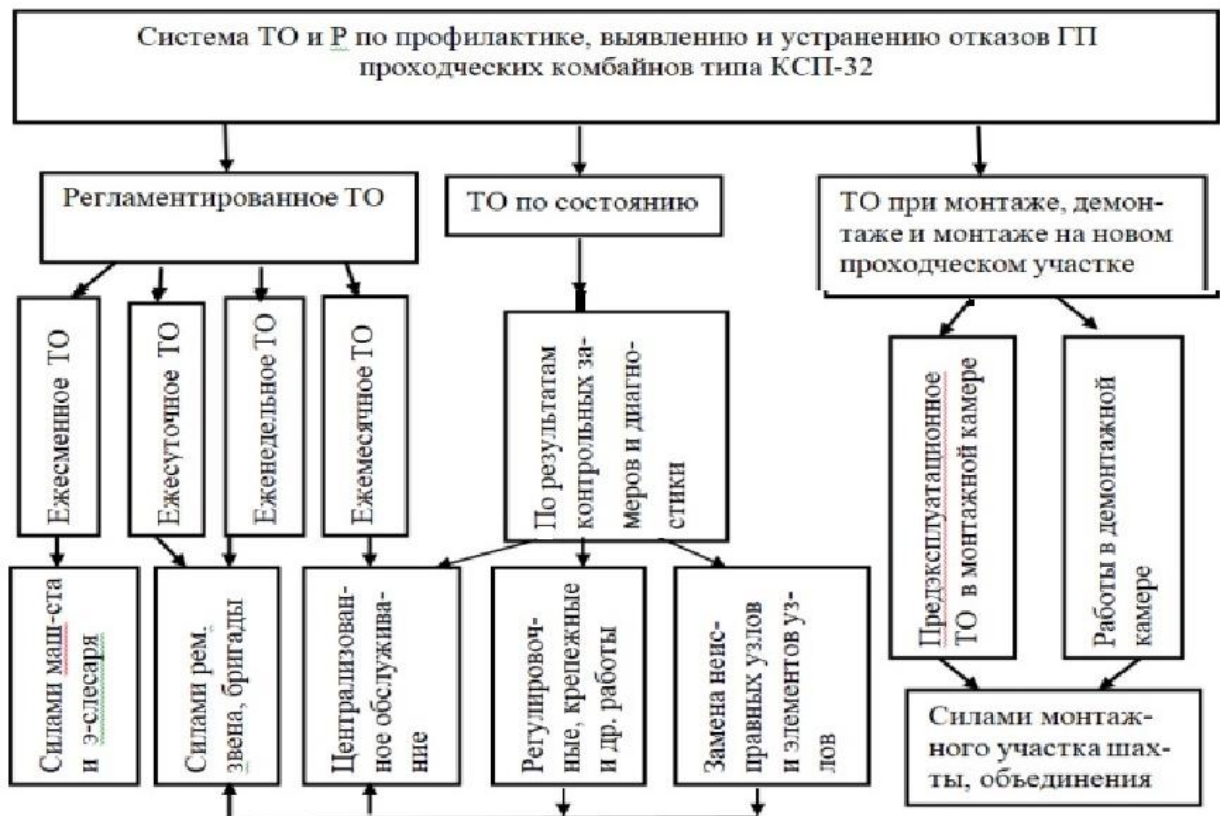
Рис. 4.7 Рациональный состав работ по техническому обслуживанию и ремонту ГП проходческих комбайнов
