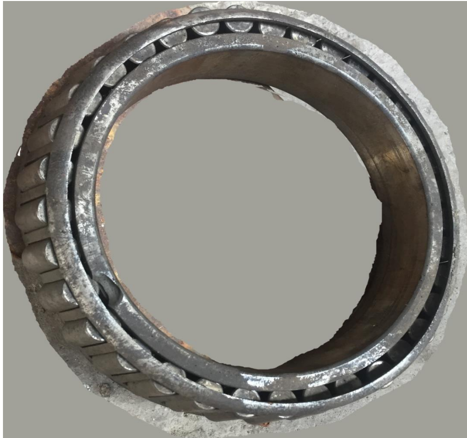
Рисунок П2.2 Дефекты подшипника гидродвигателя
