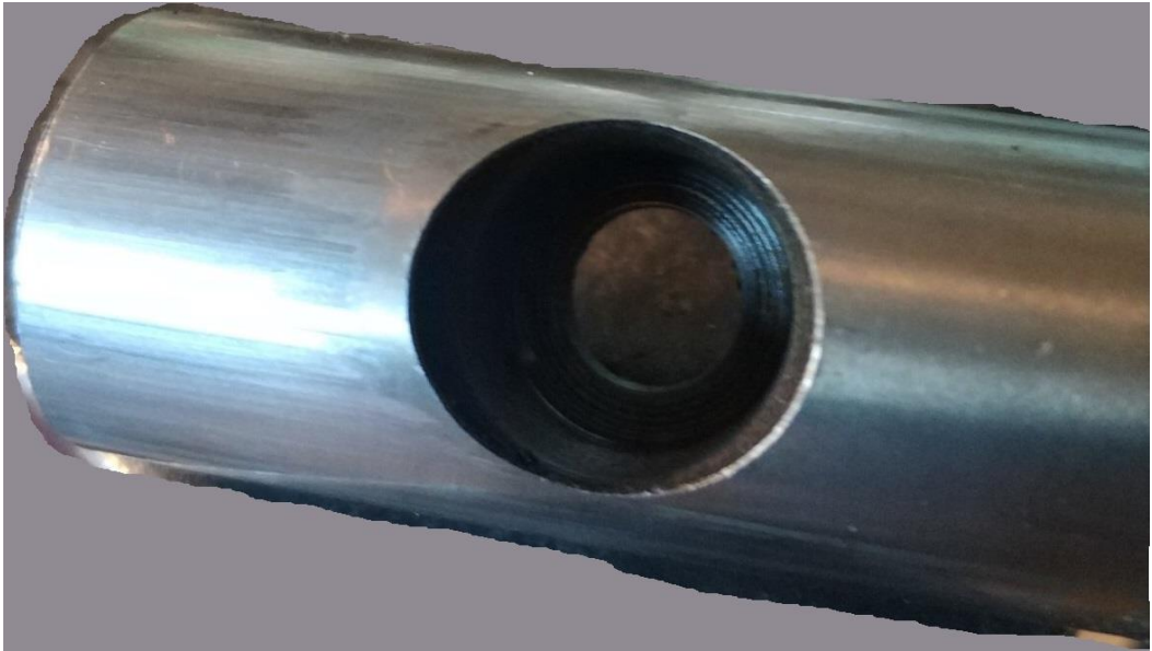
Рисунок П2.4 Износ плунжера гидродвигателя
