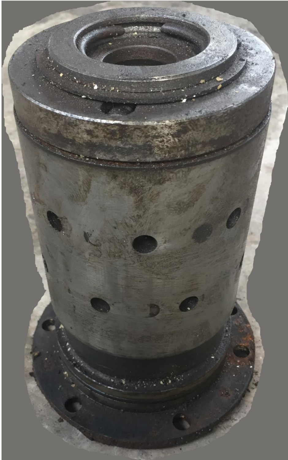
Рисунок П2.6 Износ распределительной втулки
