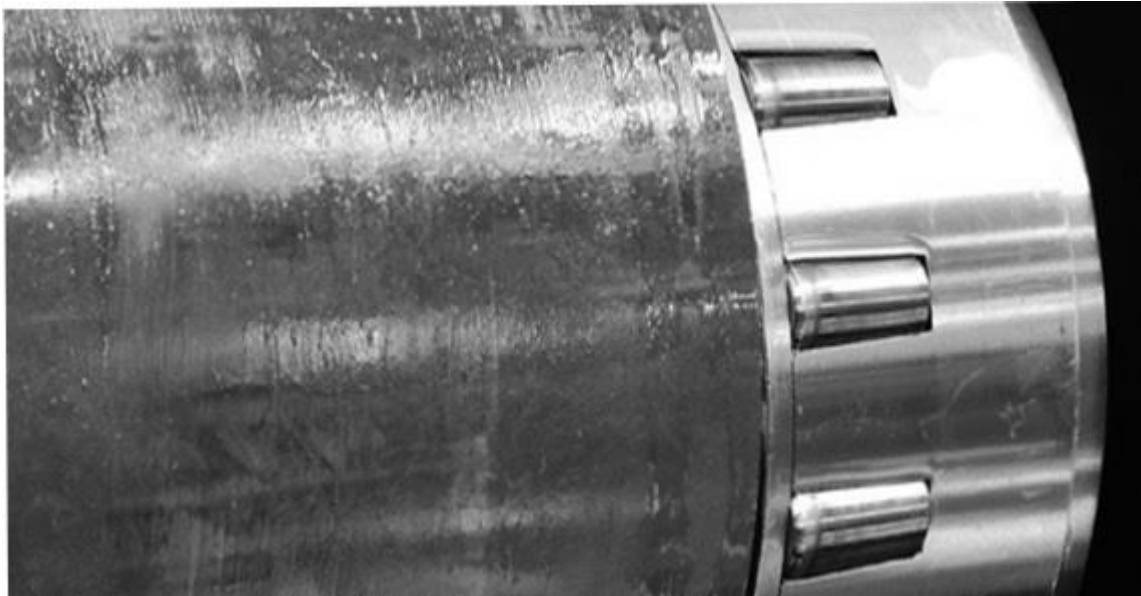
Рисунок 6.4. Раскатная головка для электромеханического упрочнения внутренней поверхности цилиндров.
