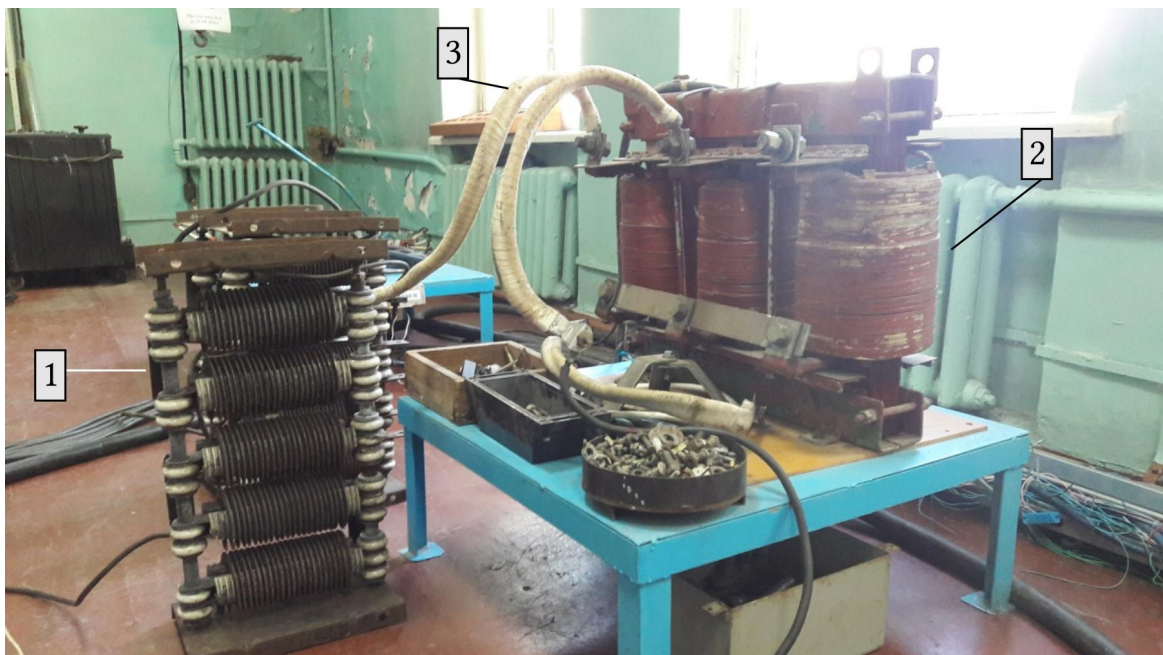
Рисунок 4.3 – Общий вид стенда: 1 — АТСК-25; 2 — ТС-10; 3 — короткая сеть
