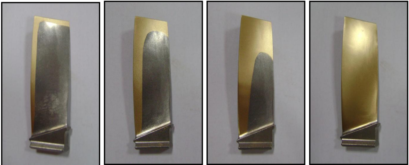
Рисунок 9. Общий вид лопатки 1-й ступени компрессора с последовательно напыленным четырехслойным ФОП (нитрид титановое): а – с одним слоем, б – с двумя слоями, в – с тремя слоями, г – с четырьмя слоями
