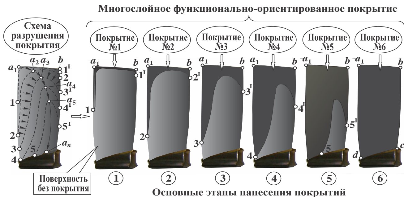
Рисунок 3. Схема формирования многослойного ФОП
