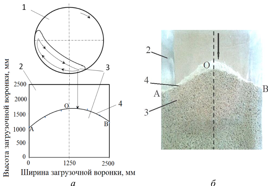
Рисунок 2. Профиль слоя шихты в бесчелноковой загрузочной воронке:
