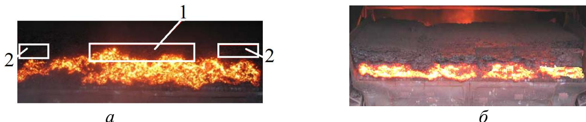
Рисунок 11. Фотография излома спека в хвостовой части агломашины до ( а ) и после ( б ) обработки поверхности слоя секционной гладилкой:
