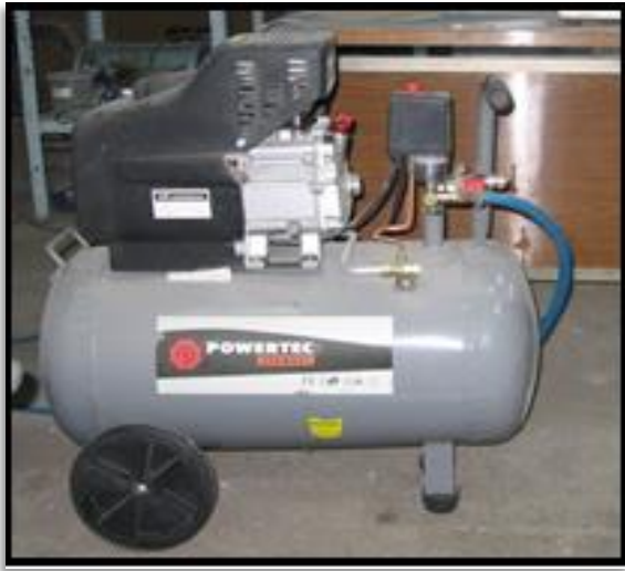
Рисунок. 19. Пневмо-абразивная компрессорная установка
