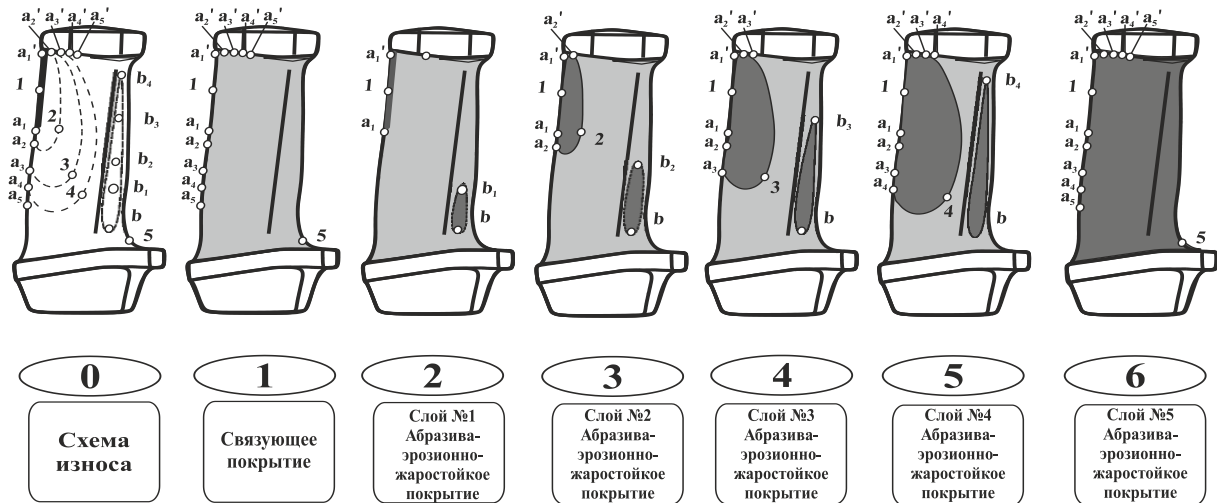
Рисунок. 10. Схема последовательности нанесения ФОП
