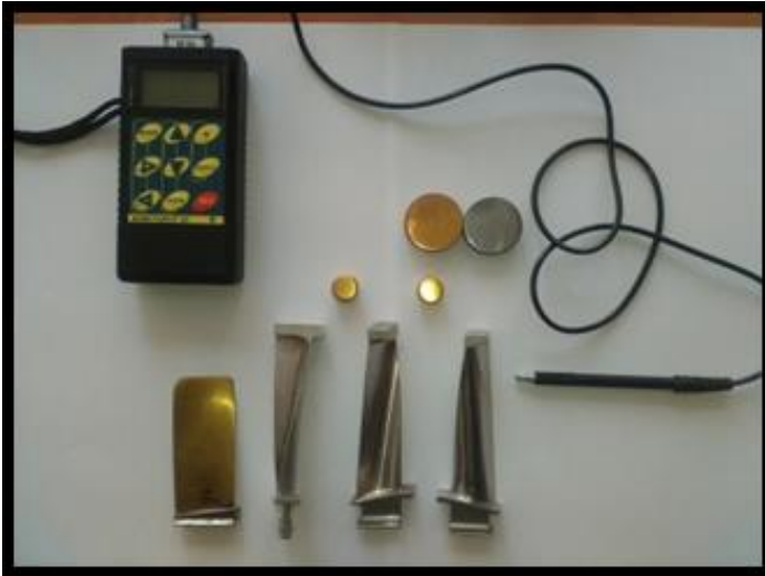
Рисунок 16. Толщиномер «Константа К5»
