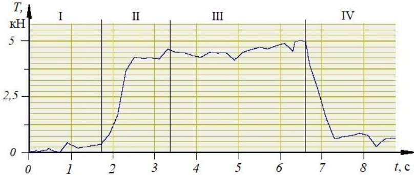
Рисунок 9 – Зависимость реализуемой тормозной силы T во времени: I – время срабатывания устройства; II – нарастание тормозной силы; III – установившаяся тормозная сила; IV – уменьшение тормозной силы после остановки
