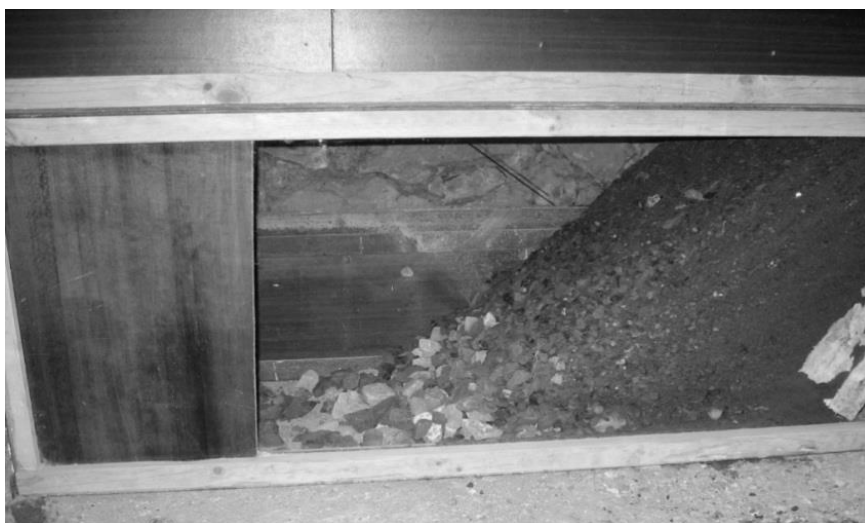
Рисунок 2 – Распределение и плотность укладки сыпучих горных пород в передней части штабеля (вид с боку)
