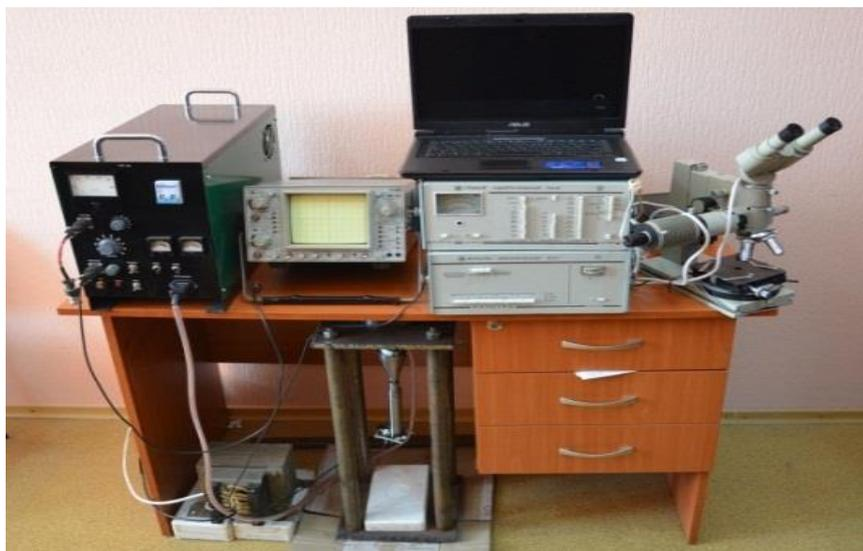
Для осуществления АООКУС была разработана акустическая виброустановка (рис. 7) включающая: 1 – генератор импульсов колебаний частот звукового диапазона с мощностью 0,4 кВт, с импульсной мощностью 30 кВт; 2 – ЗКС, 3 – осциллограф, 4 – виброметр ПИ-19, 5 – система регистрации и управления на базе ПК.
