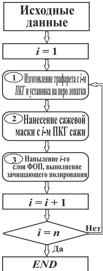
Рисунок 7. Алгоритм реализации технологического процесса формирования ФОП с ПКГ каждого слоя
