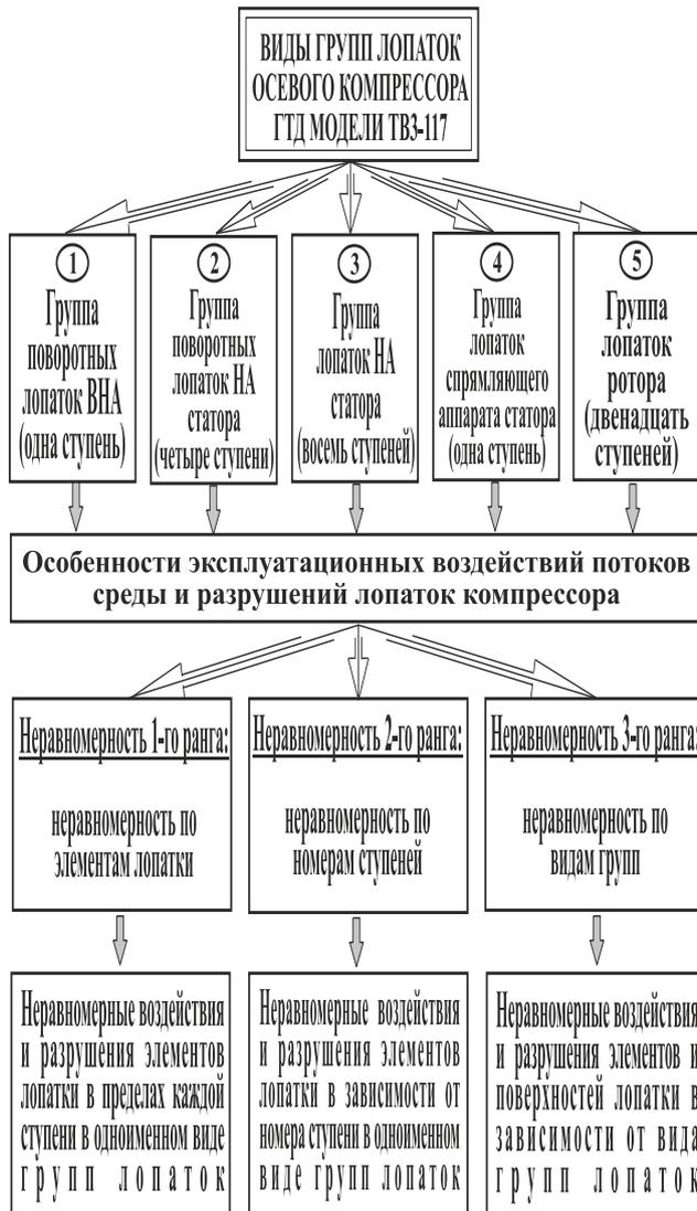
Рисунок 1. Виды групп лопаток осевого компрессора ГТД модели ТВЗ-117 и особенности их разрушений
