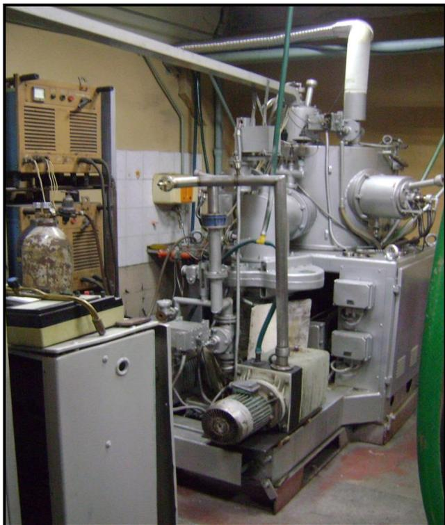
Рисунок 10. Общий вид установки ННВ 6,6 – И1 для напыления ФОП лопаток
