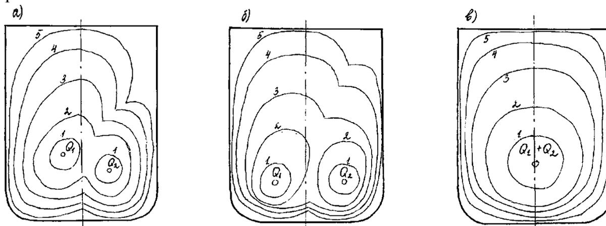
Рисунок 2 –Результаты моделирования распределения значений концентрации твердой фазы для различных положений источников:
