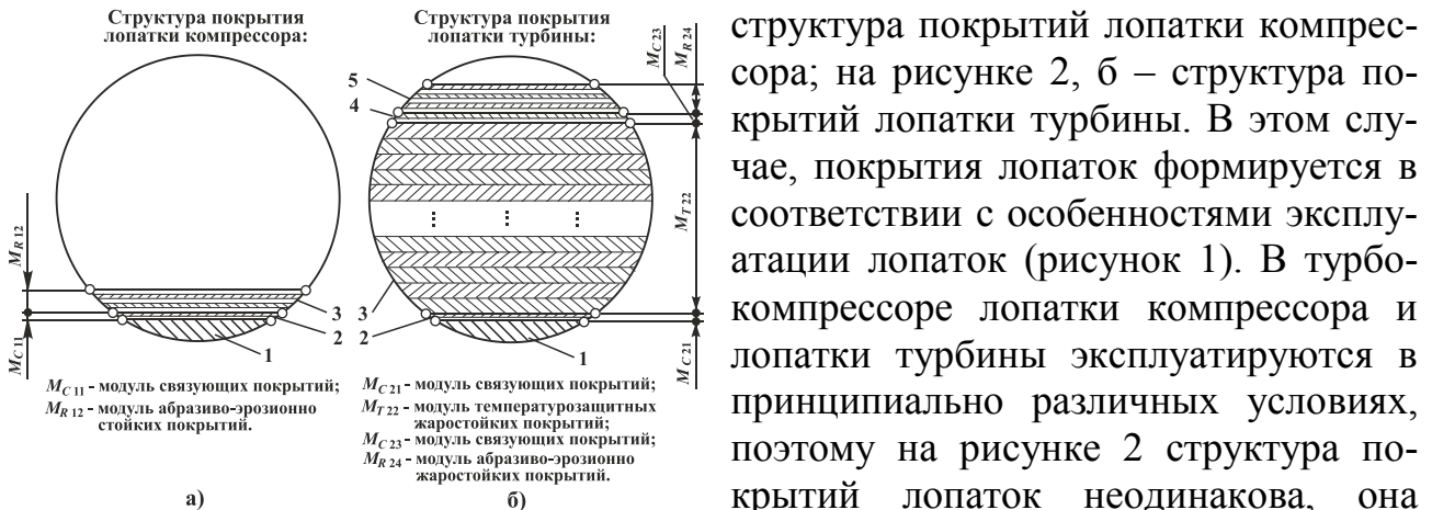
Рисунок 2. Гипотетические схемы структуры покрытий: а – лопатки компрессора, б – лопатки турбины
