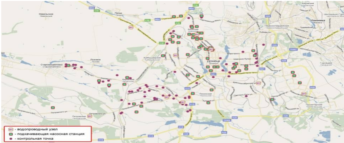
Рисунок 3 – Сеть наблюдений и управления системы технологического мониторинга КП «Донецкгорводоканал»
