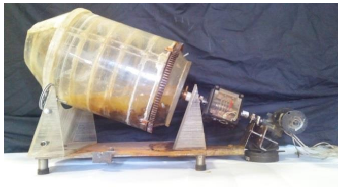
Рисунок 3. Модель конвертера с размещённым тензорезисторным преобразователем между задней цапфой и приводом
