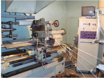
Рисунок 2. Намоточный станок с пультом и шкафом управления
