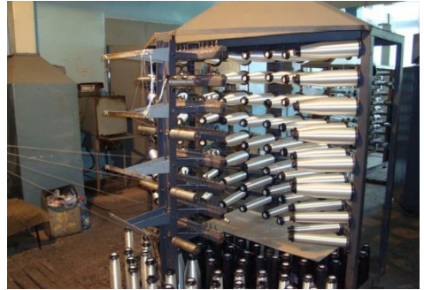
Рисунок 3. Шпулярник с 64 одновременно сходящими нитями
