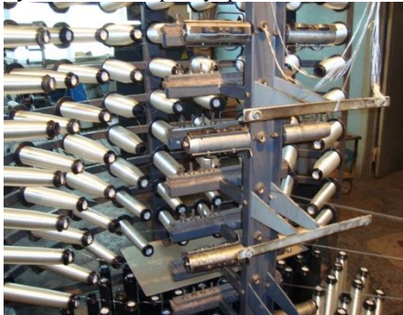
Рисунок 4. Узел предварительного натяжения нити
