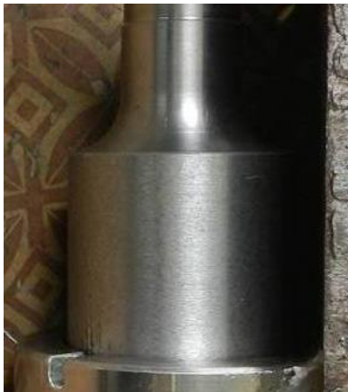
Рисунок 8 – Концентратор ступенчатой формы
