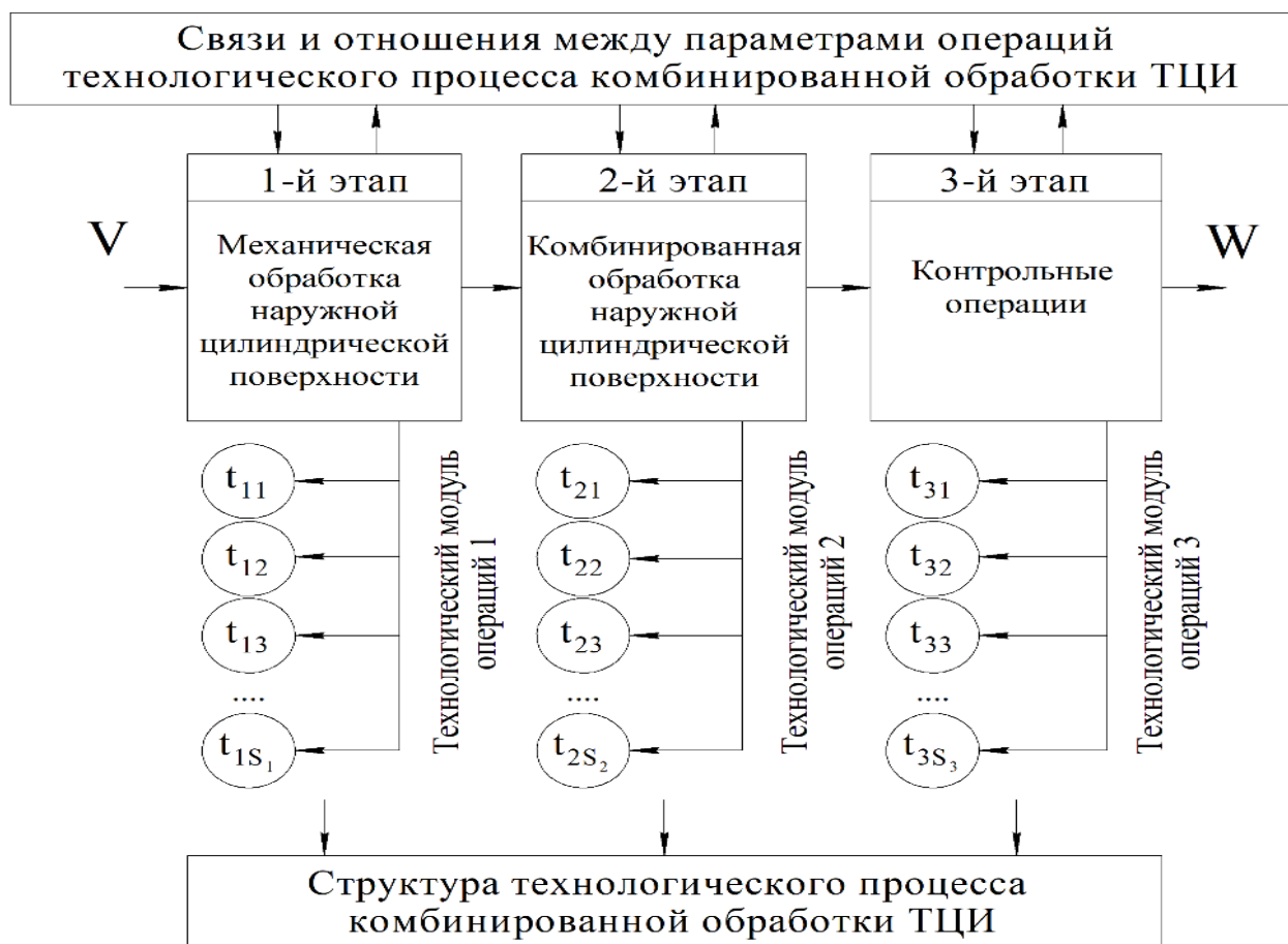
Рисунок 5 – Общая укрупненная универсальная структура технологического процесса ультразвуковой обработки тонкостенных цилиндрических изделий
