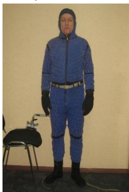
Рисунок 9 – Внутренний теплозащитный комбинезон водяного охлаждения с устройством для отбора воды из пожарного рукава
