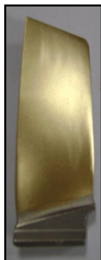
Рисунок 5.9. Лопатка компрессора с 4-м слоем ФОП
