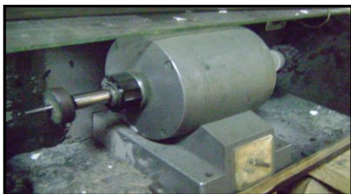
Рисунок 5.10. Общий вид установки для полировки лопаток компрессора
