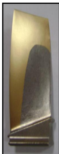
Рисунок 5.8. Лопатка ком- прессора с 3- м слоем ФОП
