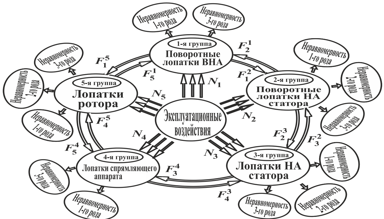
Рисунок 2.21. Структурная схема взаимосвязей различных групп лопаток и возникающих неравномерностей их разрушения при эксплуатации
