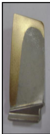
Рисунок 5.7. Лопатка компрессора со 2-м слоем ФОП
