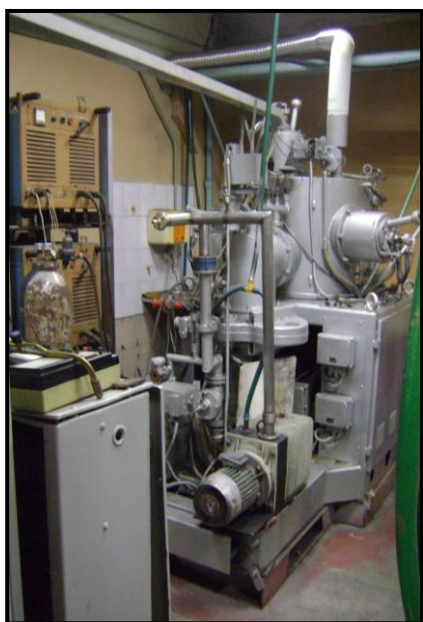
Рисунок 5.3. Общий вид вакуумной установки ННВ 6,6 – И1 для напыления ФОП лопаток компрессора
