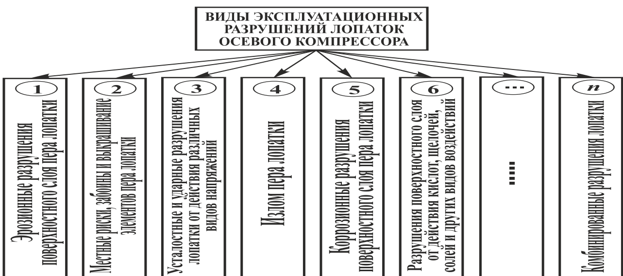
Рисунок 2.11. Виды эксплуатационных разрушений лопаток осевого компрессора ГТД
