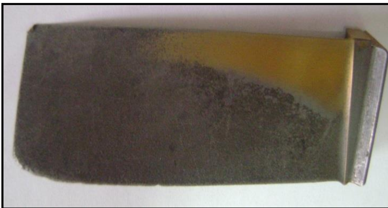
Рисунок 2.17. Особенности износа пера рабочей лопатки ротора
