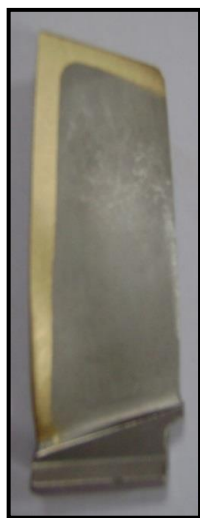
Рисунок 5.6. Лопатка ком- прессора с 1- м слоем ФОП
