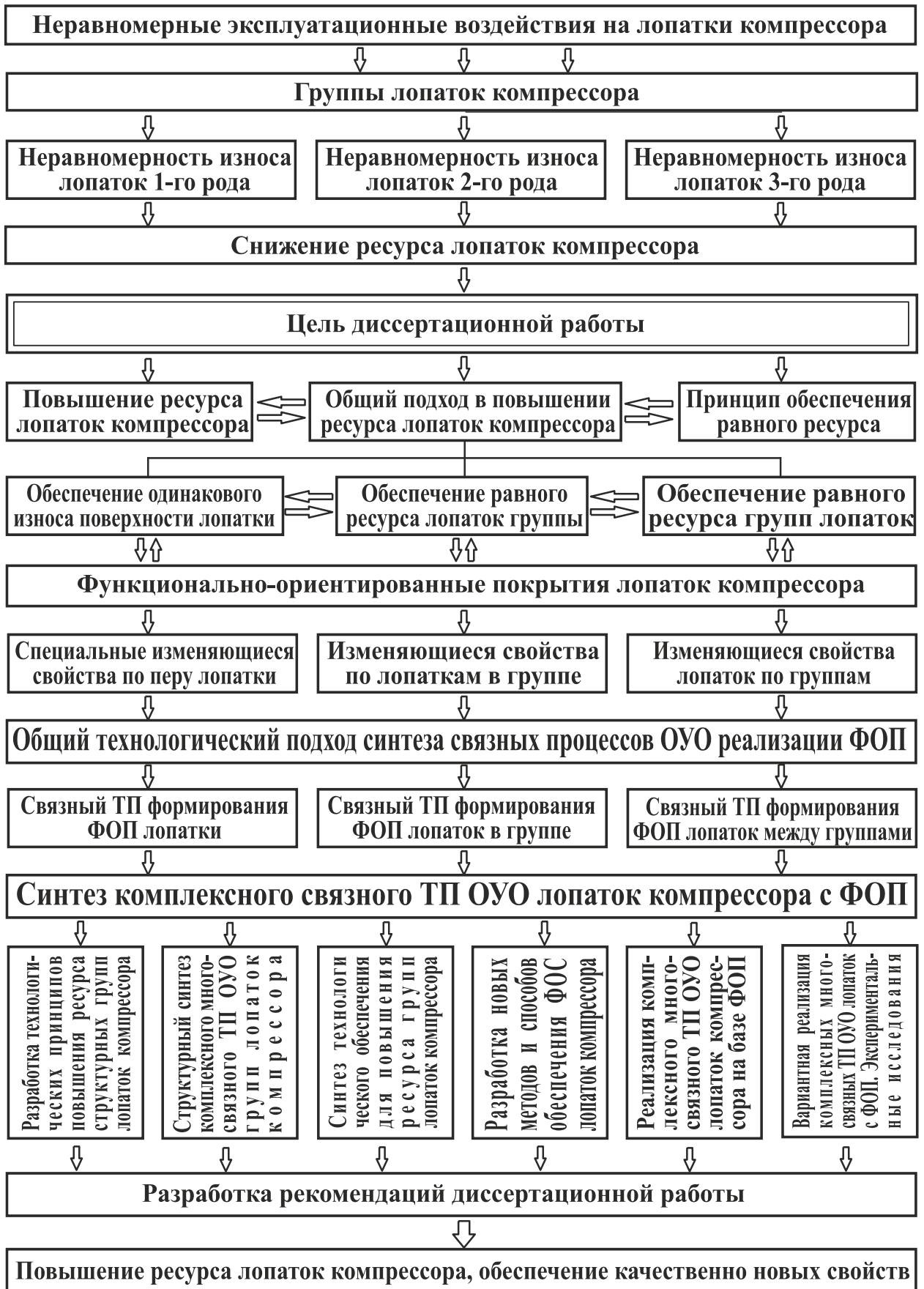
Рисунок 2.28. Структурная схема исследований диссертационной работы
