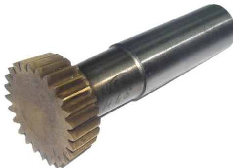
Рис. 5.9. Долбяк прямозубый хвостовой зуборезный М1.5xZ20
