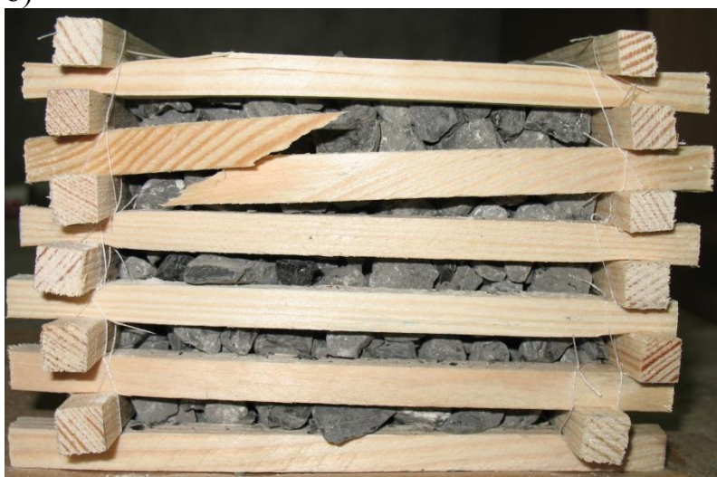
Рисунок 3.14 - Модель с податливой опалубкой и патроном с НРС после 30 шагов нагружения: а) – вид сверху; б) – вид сбоку
