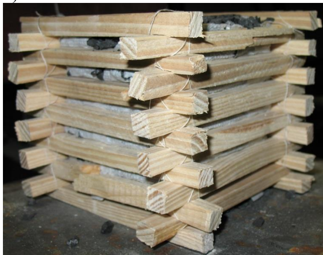
Рисунок 3.10 - Модель с податливой опалубкой без НРС после 30 шагов нагружения: а) – вид сверху; б) – вид сбоку
