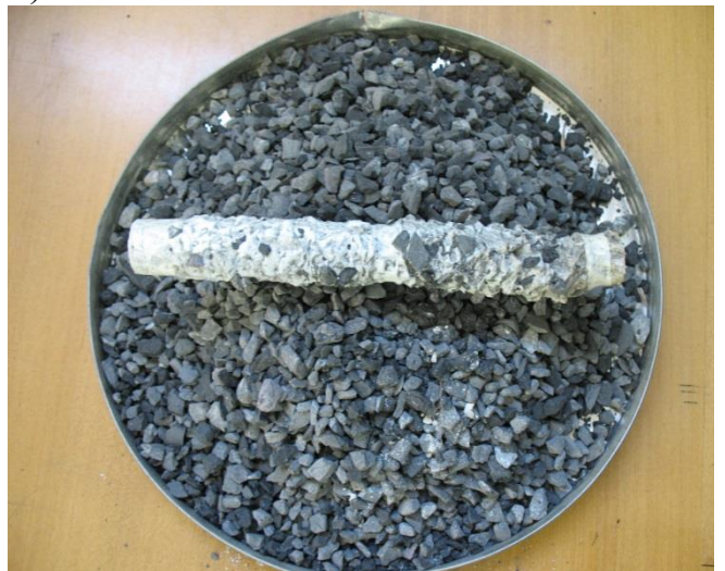
Рисунок 3.8. - Модель с патроном с НРС после 30 шагов нагружения:
