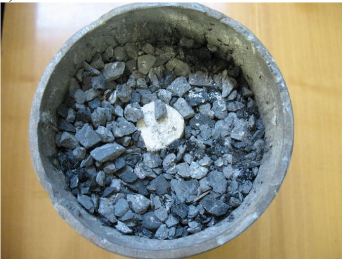
Рисунок 3.8. - Модель с патроном с НРС после 30 шагов нагружения:
