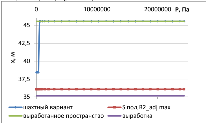
Рисунок Ш.15 - График зависимости x , м горизонтальной координаты места расположения сжимающих напряжений в слое 4 от давления, прикладываемого в верхней грани модели P , Па ( Ш_{п} = 15 м)
