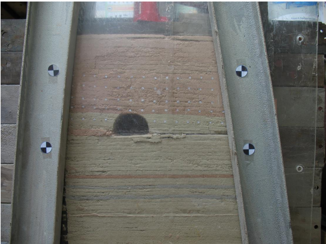
Рисунок 2.6 - Модель на момент возникновения устья магистральной трещины (предлагаемый вариант)
