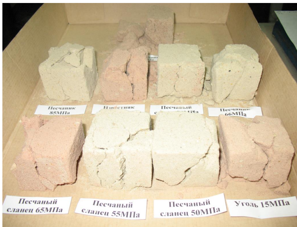
Рисунок Б.2 - Контрольные образцы из эквивалентного материала по уточненной рецептуре
