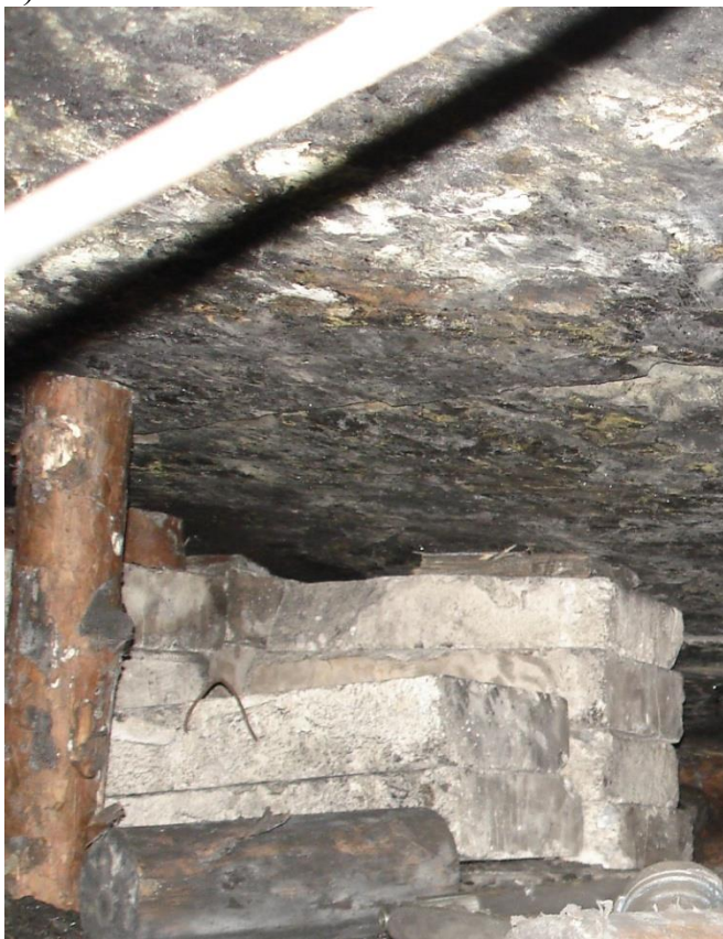
Рисунок 4.2 - Зазор между кровлей и охранным сооружением: а) – для шахты «Рассвет-1»; б) – для шахты «Щегловская–Глубокая»;
