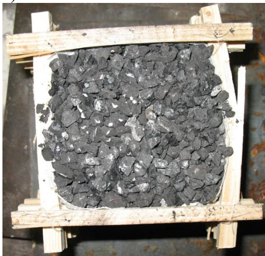
Рисунок 3.10 - Модель с податливой опалубкой без НРС после 30 шагов нагружения: а) – вид сверху; б) – вид сбоку
