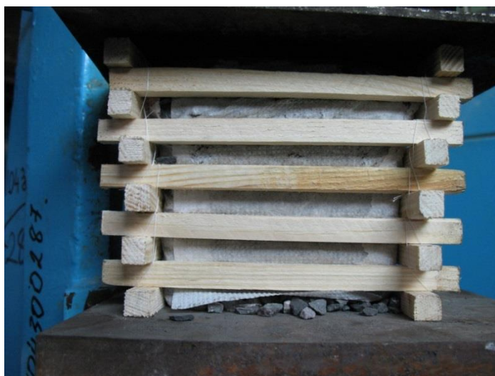
Рисунок 3.12 - Модель с податливой опалубкой и эластичной оболочкой с НРС до нагружения
