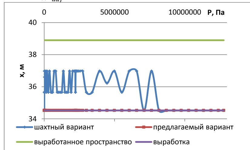
Рисунок 5.37 - График зависимости x, \text{м} горизонтальной координаты места расположения максимального контактного давления на контакте «слой 4 – блок 7» от давления, прикладываемого к верхней грани модели P, \text{Па} ( \text{Ш}_0 = 50\text{м} )
