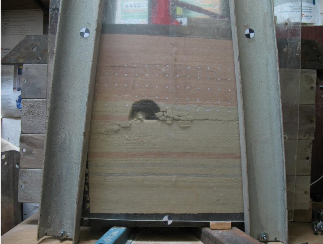
Рисунок 2.5 - Модель на момент обрушения консоли основной кровли (шахтный вариант)
