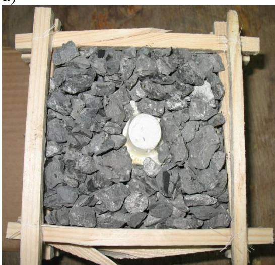
Рисунок 3.14 - Модель с податливой опалубкой и патроном с НРС после 30 шагов нагружения: а) – вид сверху; б) – вид сбоку
