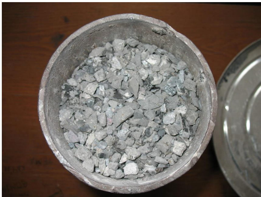
Рисунок 3.4 - Вид сверху на модель без НРС после 30 шагов нагружения
