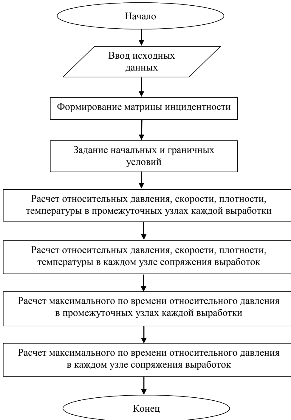
Рисунок 5.2. Блок-схема расчёта распространения и взаимодействия воздушных ударных волн в сети горных выработок
