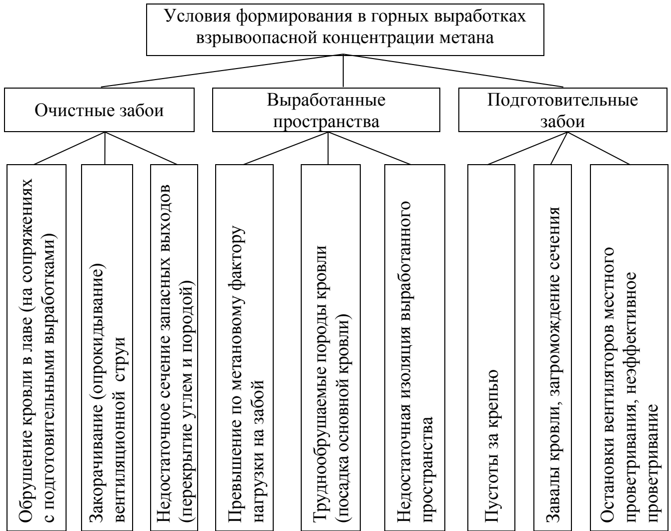
Рисунок 2.2. Схема формирования в горных выработках взрывоопасной концентрации метана
