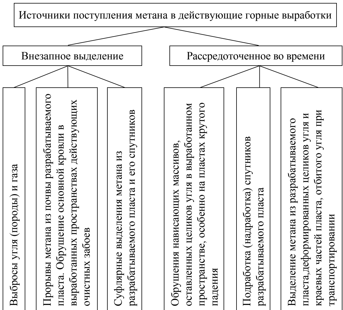
Рисунок 2.1. Схема образования источников поступления метана в горные выработки
