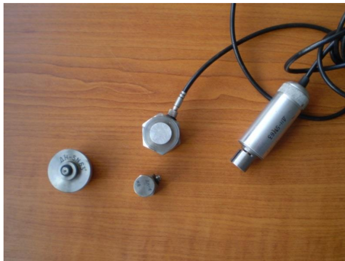
Рисунок 3.21 - Вибродатчики ДН-3, ДН-4, ДН-5
