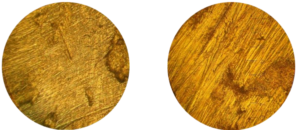
Рисунок 4.9 - Топография поверхности пластины Ст 40 после обработки:
