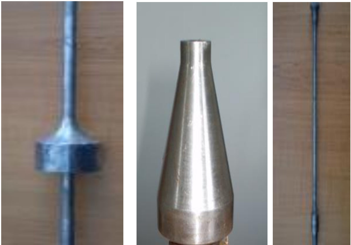
Рисунок 3.15 - Концентраторы ЗКС: а) №1, профильно-цилиндрический, б) №2, конусообразный; в) №3, цилиндрический.
