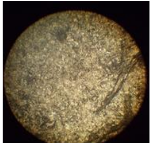
Рисунок 4.5 - Топография поверхности Ст 45 после точения (1:500)
