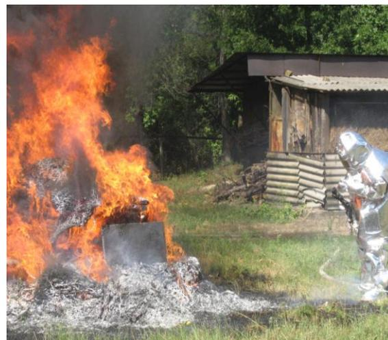
Рисунок 3.19 - Контроль испытателем температуры в пододежном пространстве противотепловой защиты
