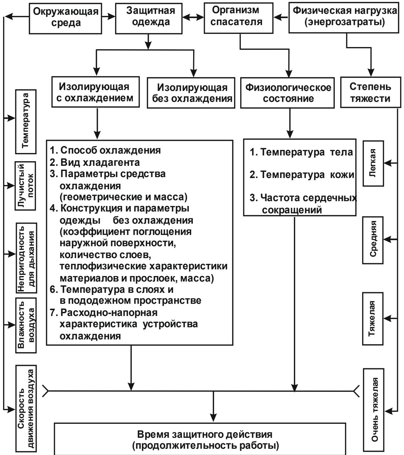
Рисунок 2.1 - Структурная схема системы «окружающая среда – противотепловая одежда – организм спасателя»
