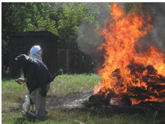
Рисунок 3.20 - Фиксация температуры пирометром на наружной оболочке противотепловой защиты
