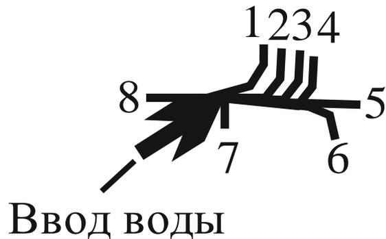
Рисунок 4.4 – Принципиальная схема подающего воду в КВО вводного коллектора к элементам противотепловой защиты: 1 – к лицевой части шлема и левой половине туловища; 2 – к затылочной части шлема и левой руке; 3 – к затылочной части шлема и правой руке; 4 – к лицевой части шлема и правой половине туловища; 5 – к передней поверхности правой ноги; 6 – к задней поверхности правой ноги; 7 – к передней поверхности левой ноги; 8 – к задней поверхности левой ноги
