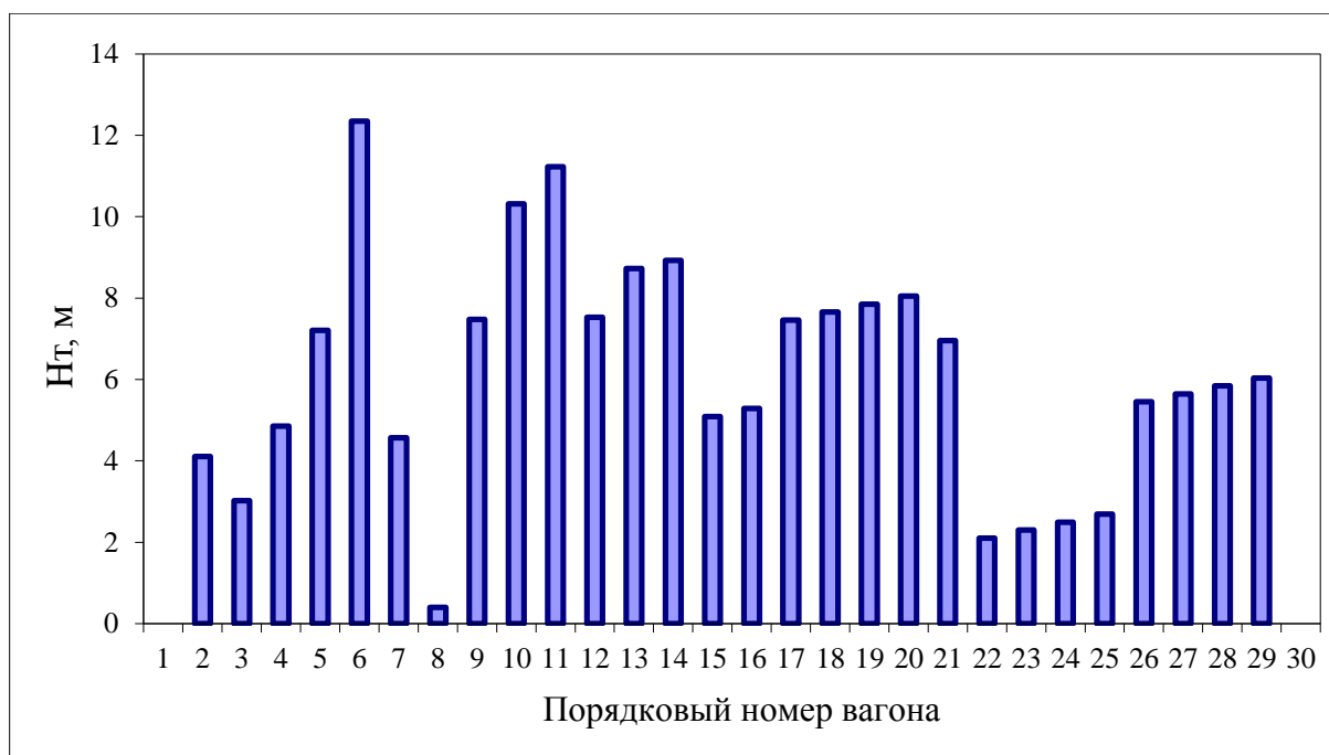
Рисунок 2.10 – Расчетный прогноз затрат энергии на замедлителях при расформировании подвижного состава
