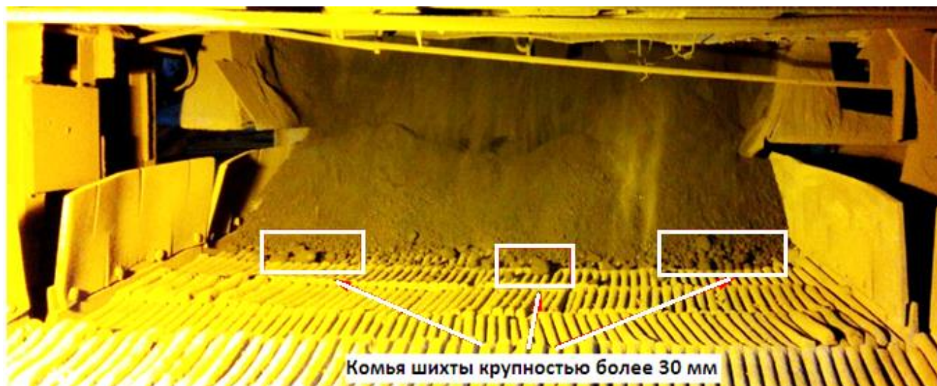
Рисунок 4.4. Загрузка шихты на агломашину ЕМЗ
