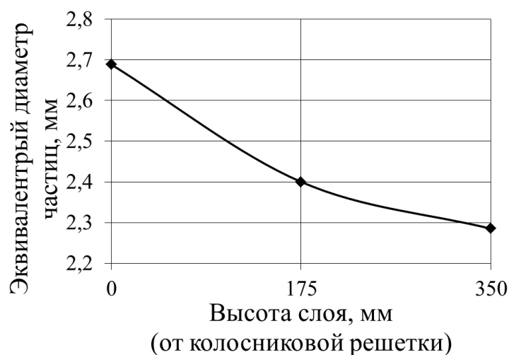
Рисунок 4.8. Распределение шихты по крупности по высоте слоя
