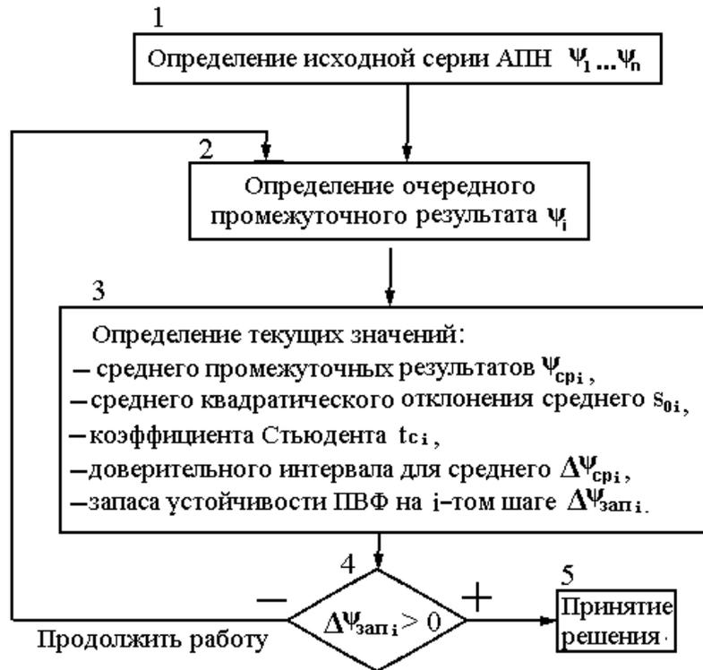
Рисунок 5.8. Фрагмент алгоритма работы УВФ. Принятие решения
