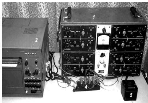
Рисунок 4.11. Общий вид комплекта измерительной и регистрирующей аппаратуры: 1 – тензоусилитель 8АНЧ7м; 2 – фоторегистрирующий осциллограф Н071.3; 3 – соединительные кабели; 4 – контактная колодка; 5 – кнопка управления пускателем конвейера и осциллографом
