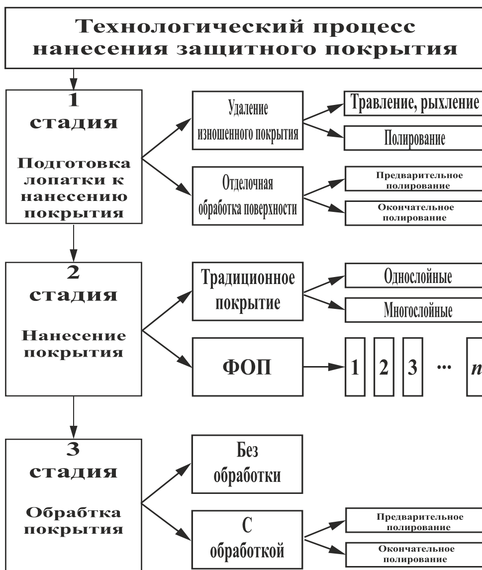
Рисунок 2.12. Основные стадии и комплексы операций обработки или восстановления лопатки турбины
