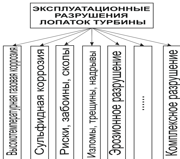
Рисунок П1.6. Виды эксплуатационных повреждений лопаток турбин ГТД
