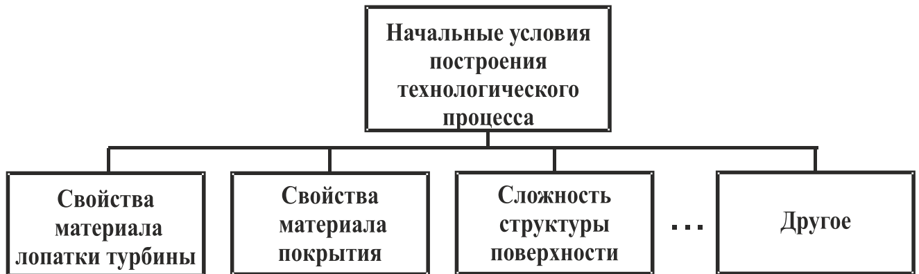
Рисунок 3.3. Общие условия построения технологического процесса обработки поверхности детали
