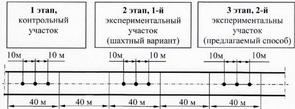
Рис. 1 Схема расположения экспериментальных участков и контурных замерных станций по длине конвейерного штрека 8-й западной лавы пласта m_3
