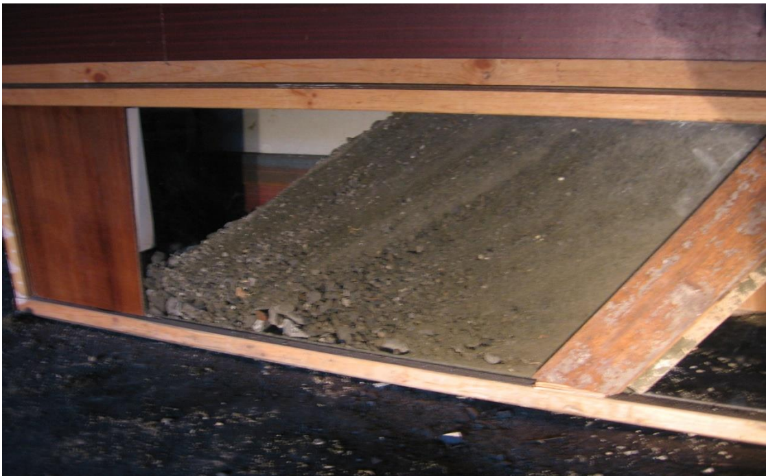
Рис. 2.11. Сечение штабеля (фото), отсыпанного на наклонное основание. Визуально отмечается разный грансостав материала по простиранию и по мощности штабеля
