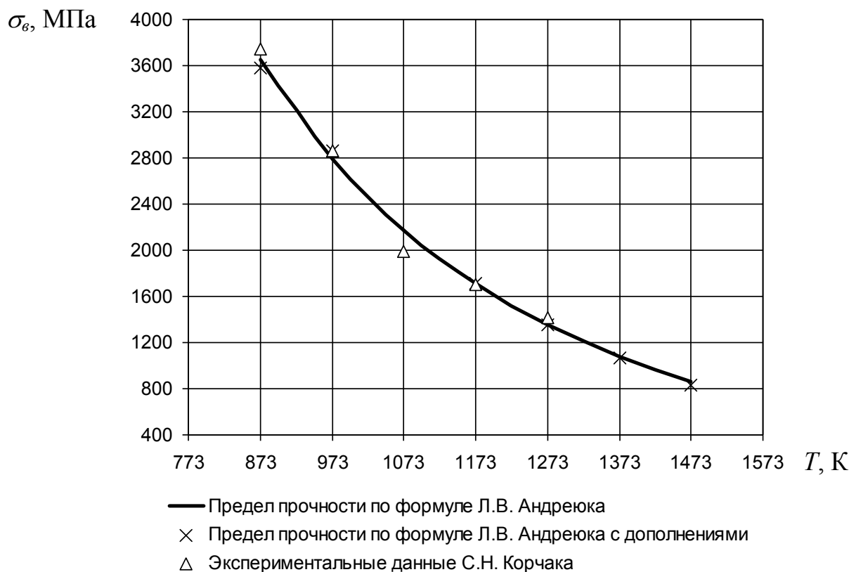
Рисунок 7.3 – Разрушающее напряжение (предел прочности) стали 18X2H4BA, определённое по формуле Л.В. Андреюка, в температурно-скоростных условиях шлифования
