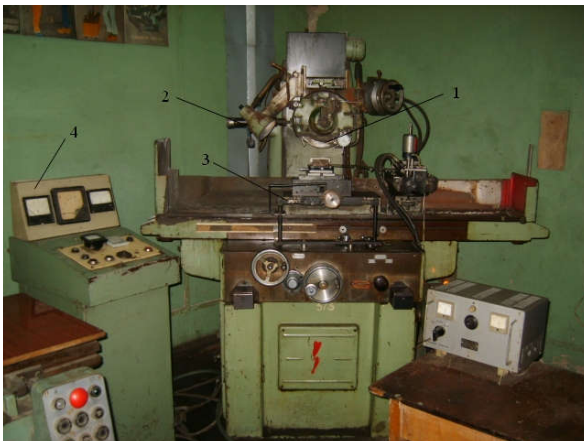
Рисунок 2.6 – Общий вид модернизированного плоскошлифовального станка модели 3Г71 с источником технологического тока ИТТ-35
