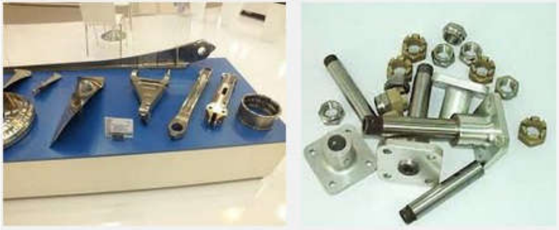
Рисунок 1.4 – Детали из титановых сплавов, подвергаемые механической обработке
