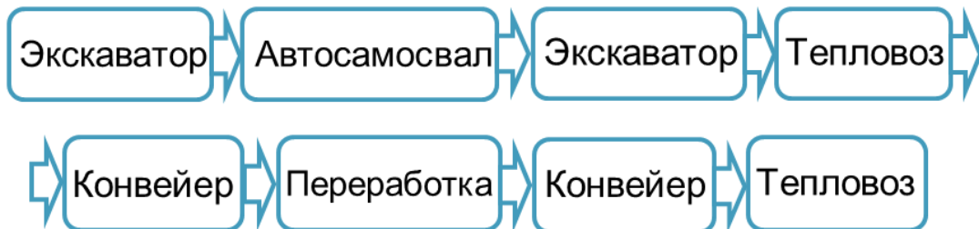
Рисунок 1.6 – Схема доставки руды с дробильно-перегрузочными фабриками
