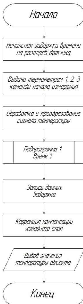
Рисунок 5.1 – Алгоритм измерения температуры слоев в крышке цилиндров
