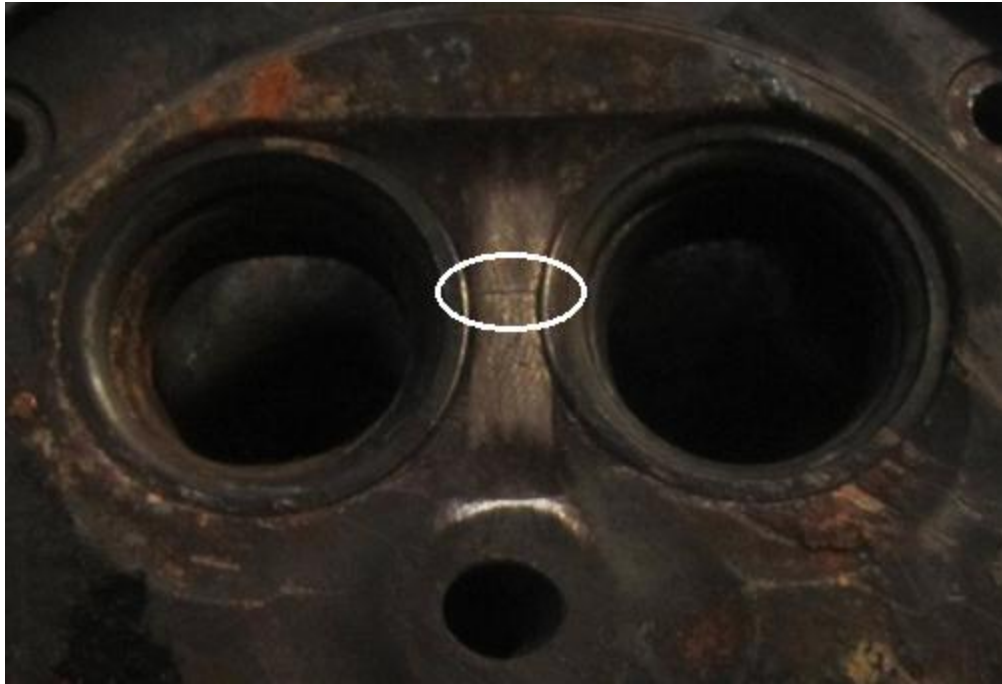
Рисунок 2.2 – Поперечная трещина межклапанной перемычки цилиндровой крышки дизельного двигателя горно-транспортной машины
