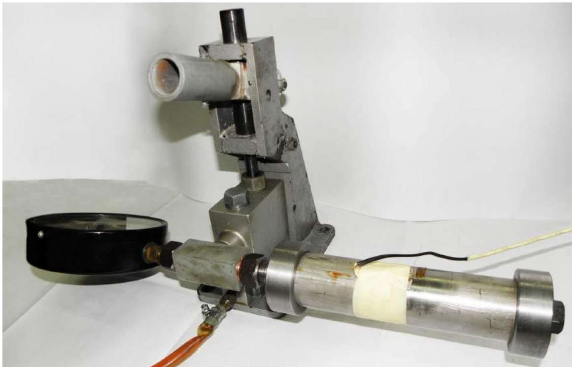
Рисунок 3.10. Схема (а) тарировки датчика радиальных напряжений и ее общий вид (б):
