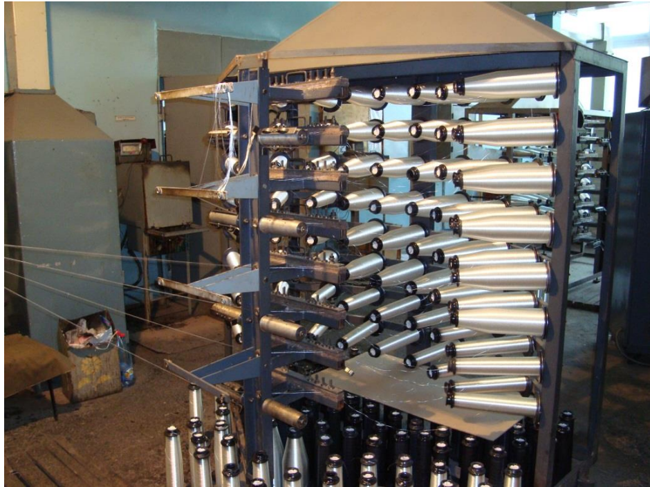
Рисунок 2.2. Шпулярник с 64 одновременно сходящими нитями
