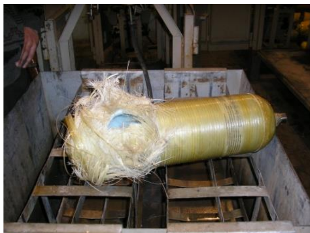
Рисунок 3.20. Внешний вид малогабаритного корпуса после испытаний на разрушение
