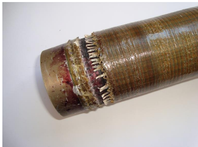
Рисунок 5.12. Вырыв шипов фланцевого соединения при испытании
