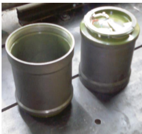
Рисунок 3.16. Лейнер малогабаритного корпуса до намотки
