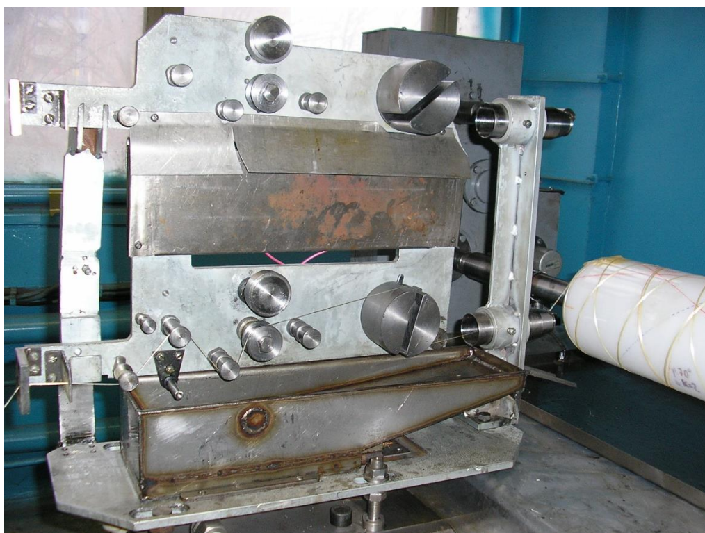
Рисунок 2.7. Пропиточно-формирующий тракт натяжения и пропитки нити (жгута)
