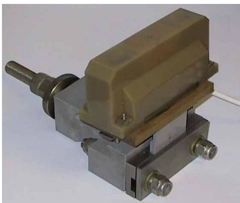
Рисунок 1.8 – Путь датчик контроля прохождения колеса поезда
