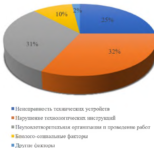
Рисунок 6.1. Факторы аварийности в металлургической отрасли за период с 2008 по 2017 год в России
