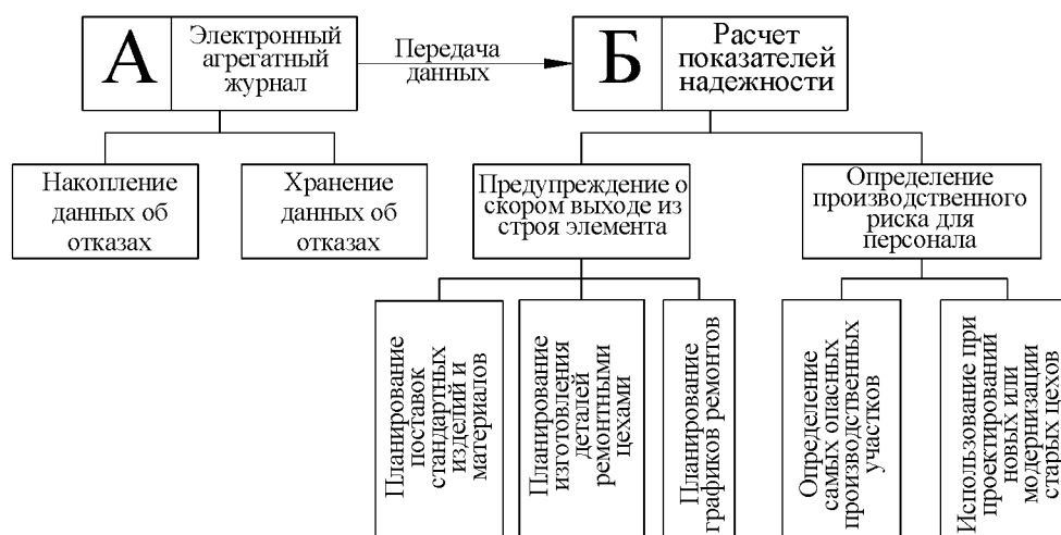
Рисунок 3.1. Схема описания системы прогнозирования отказа оборудования
