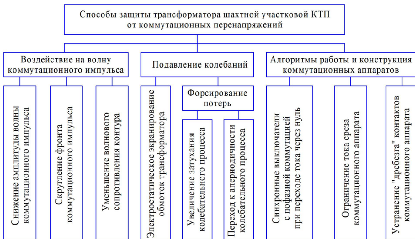
Рисунок 1.13 – Классификация методов защиты трансформатора шахтной участковой КТП от коммутационных перенапряжений
