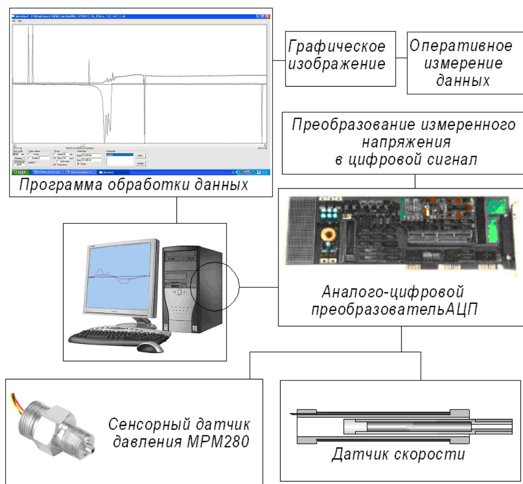
Рис. 3.6. Измерительно-регистрающая схема стенда
