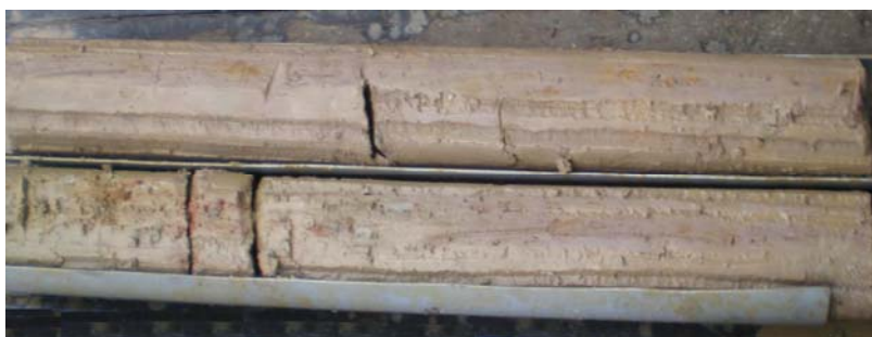
Рис. 4.3. Образец керна твердых красных глин с интервала 2,4 - 4,5 м (опытная скважина №1 в порту г. Вунг Тау).
