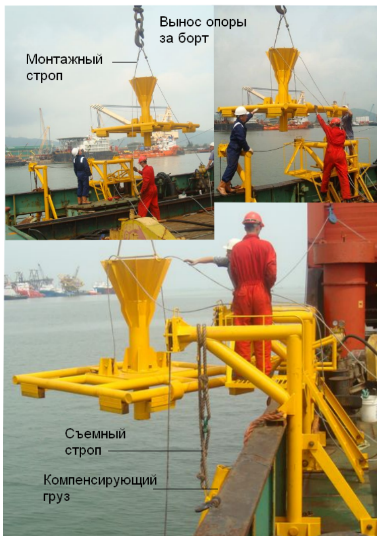
Рис. 4.2. Размещение оборудования установки УМБ-130М на НИС «Триас» и подготовительные работы по спуску донной опоры на дно.
