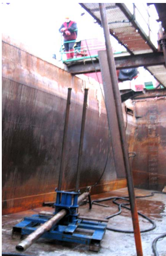
Рис. 4.5. Размещение установки УМБ-130 в хоппере теплохода «Трофа»
