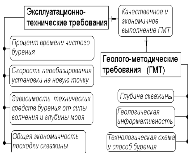
Рис. 1.1. Основные пункты геолого-методических и эксплуатационно-технических требований к бурению скважин на шельфе
