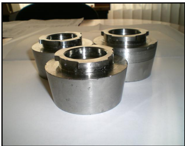
Рисунок 5.7. Общий вид катодов из титанового сплава ВТ 1-0 для установки ННВ 6.6-И1 для напыления лопаток компрессора
