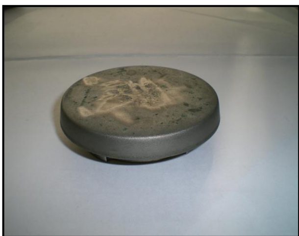
Рисунок 5.8. Общий вид катода установки ННВ 6.6-И1, отработавшего 7 часов
