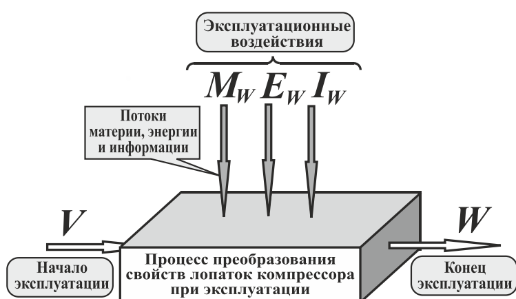
Рисунок 2.1. Модель процесса преобразования свойств лопаток компрессора при эксплуатации
