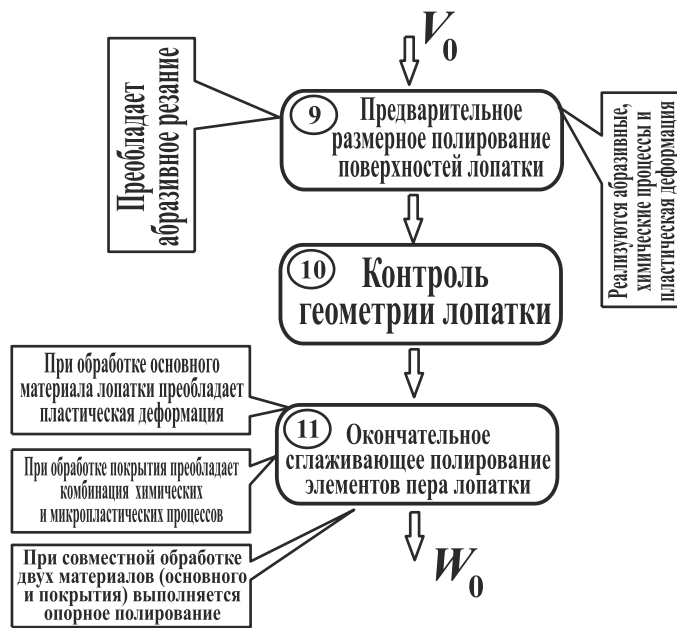
Рисунок 3.3. Структура 1-го этапа технологического процесса отделочной обработки пера новых лопаток
