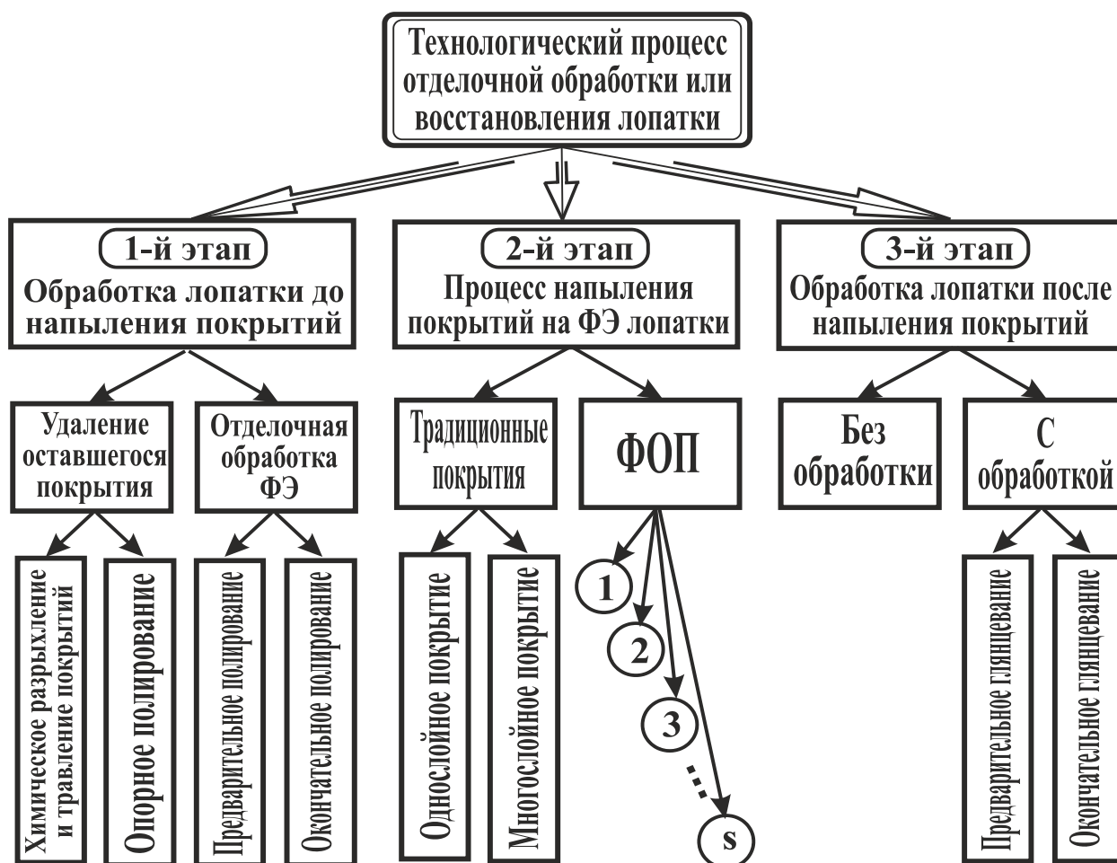
Рисунок 2.14. Основные этапы и операции отделочной обработки или восстановления лопатки компрессора
