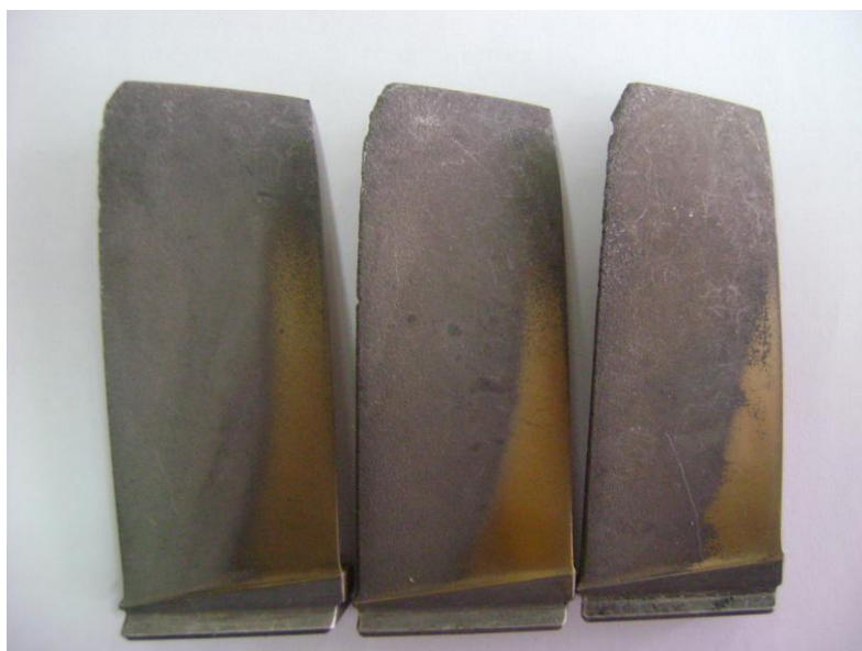
Рисунок 1.4. Лопатки компрессора со значительным износом входной, выходной кромки и поверхности корыта пера
