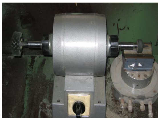
Рисунок П4.3. Полировальный станок для специальной обработки изделий с покрытиями
