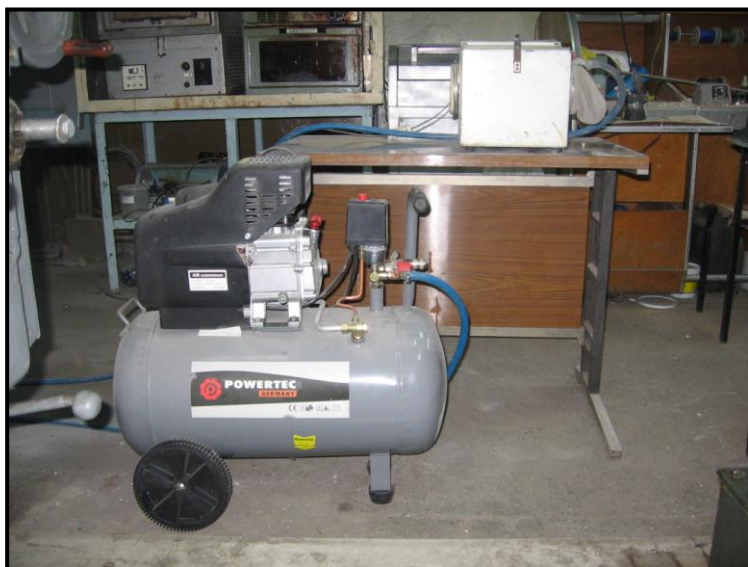
Рисунок 5.13. Установка для пневмо абразивно-струйной обработки лопаток компрессора
