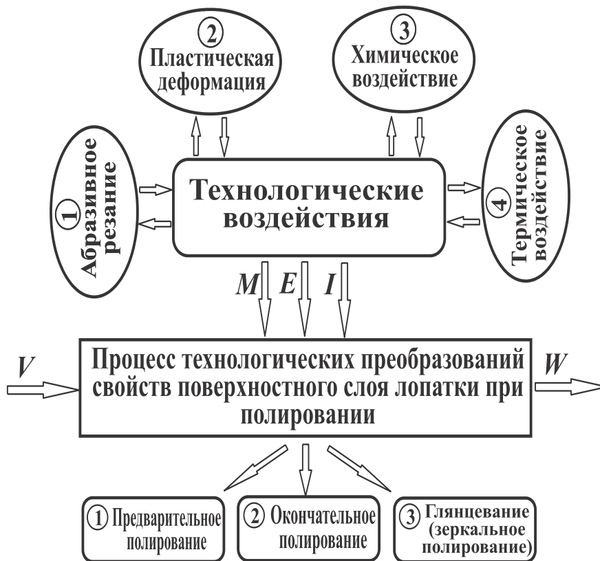
Рисунок ПЗ.1. Системная модель процесса технологических преобразований свойств поверхностного слоя лопатки при полировании
