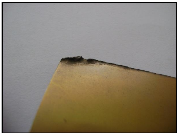
Рисунок 2.6. Общий вид заусенца по задней кромке пера лопатки
