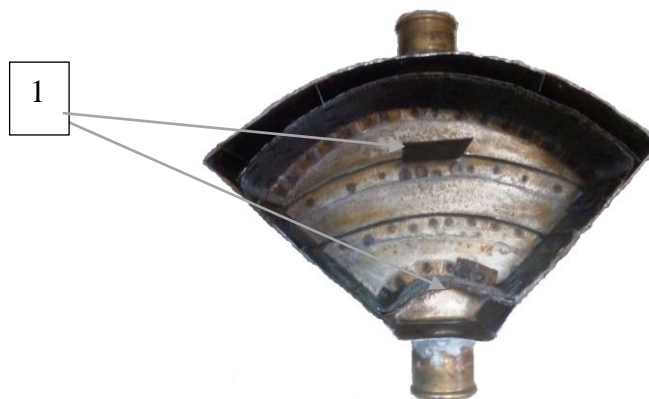
Рисунок 3.6 – Секторный регенеративный патрон, снаряженный кислородсодержащим продуктом
