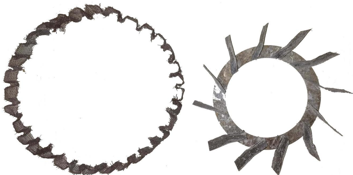
Рисунок 2 – Элементы теплогазораспределителя усовершенствованного макетного образца регенеративного патрона респиратора
