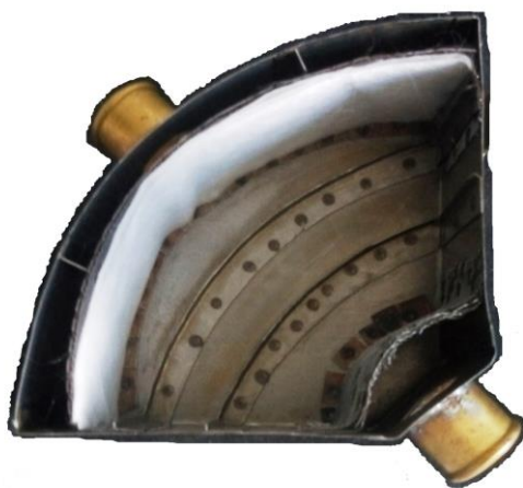
Рисунок 3.4 – Схема секторного регенеративного патрона
