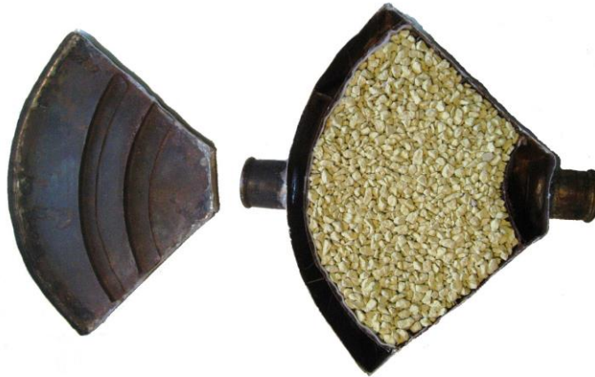
Рисунок 3.6 – Секторный регенеративный патрон, снаряженный кислородсодержащим продуктом
